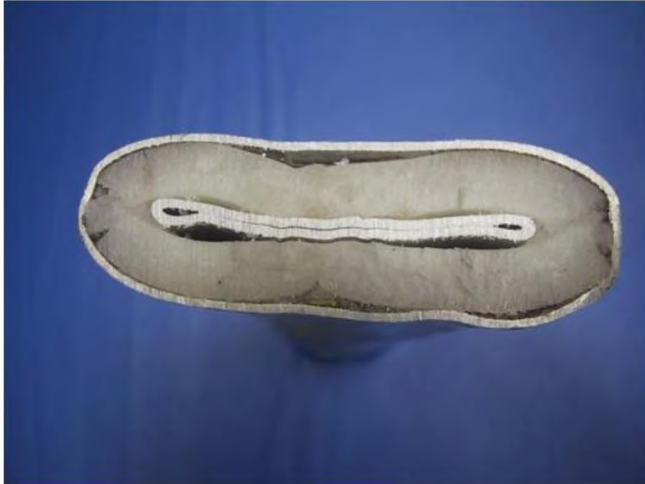
Figura 3.8: Seção do corpo de prova PIP.M2.G1.I02 colapsado [18].
