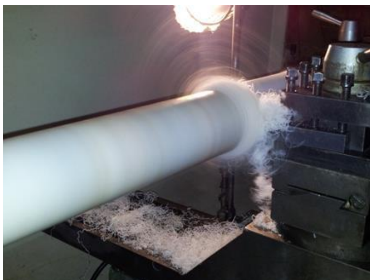
Figura 3.5: Usinagem do anular de PVDF dos modelos de Castillo [34]
