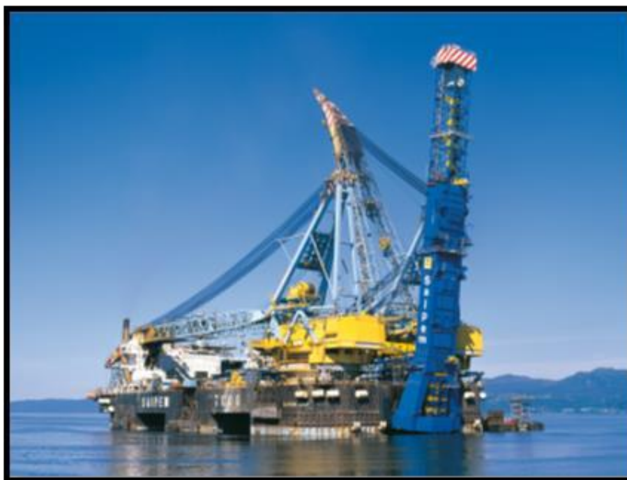
Figura 2.15: Saipem 7000 em operação desde 1998. Capacidade de instalar dutos de 4" a 32" de diâmetro [17].
