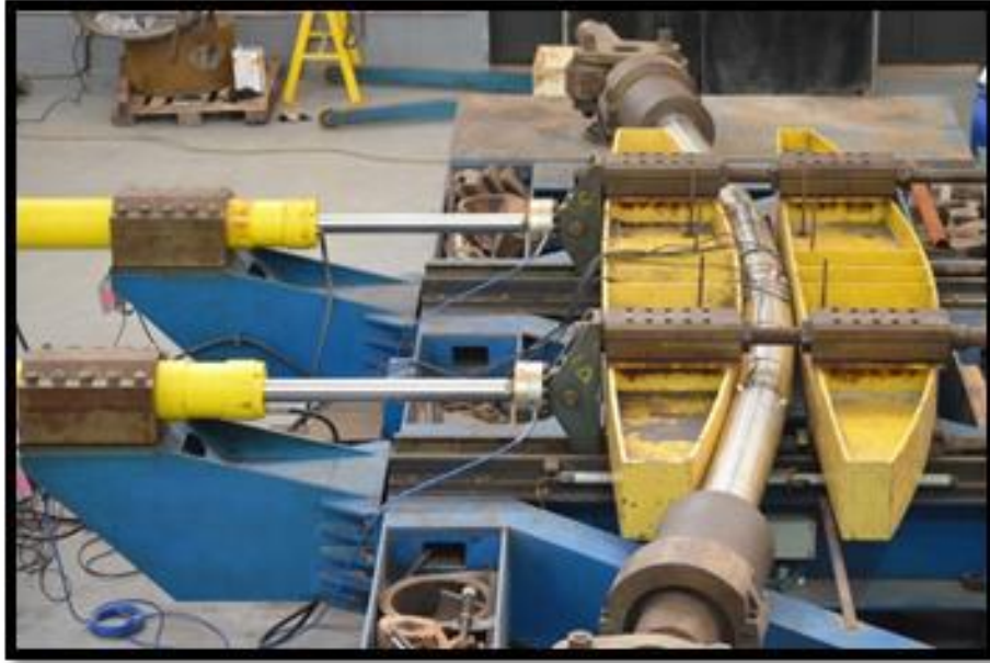
Figura 2.19: Teste de dobramento do duto sanduíche realizado no LTS [7]
