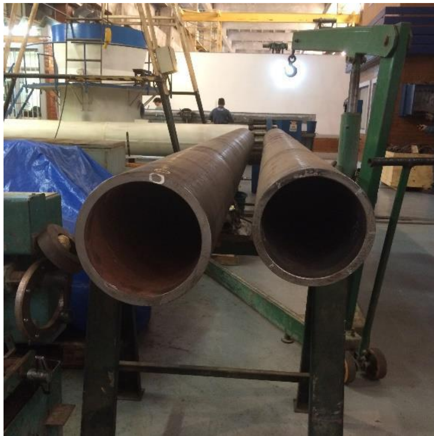
Figura 1.2: Tubos de parede simples.
