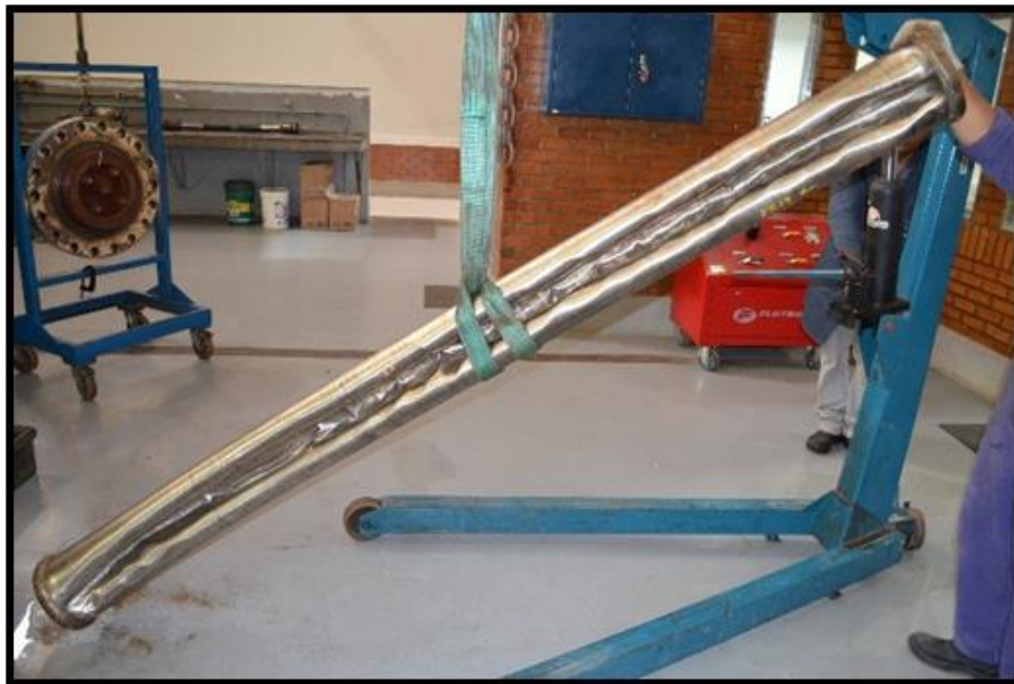
Figura 2.20: Protótipo do duto sanduíche SP-2A colapsado [7]
