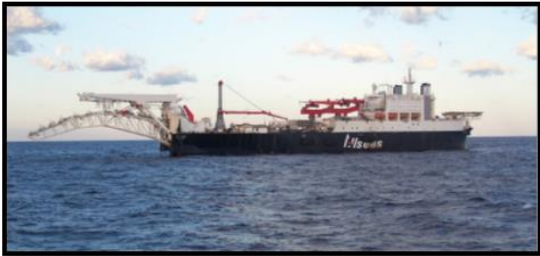
Figura 2.17: Navio Solitaire , um dos maiores navios de lançamento de método S-Lay do mundo, com 300 m de comprimento, excluindo o stinger [18].
