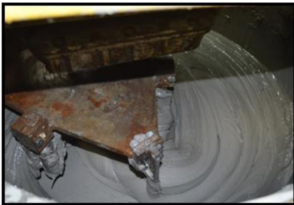
Figura 2.2: Fabricação do composto SHCC [7]
