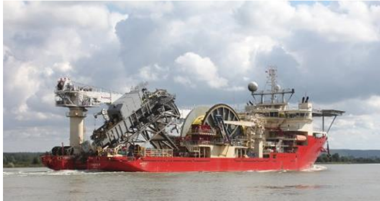
Figura 9 - Embarcação utilizada para instalação e remoção de dutos por bobina reversa
