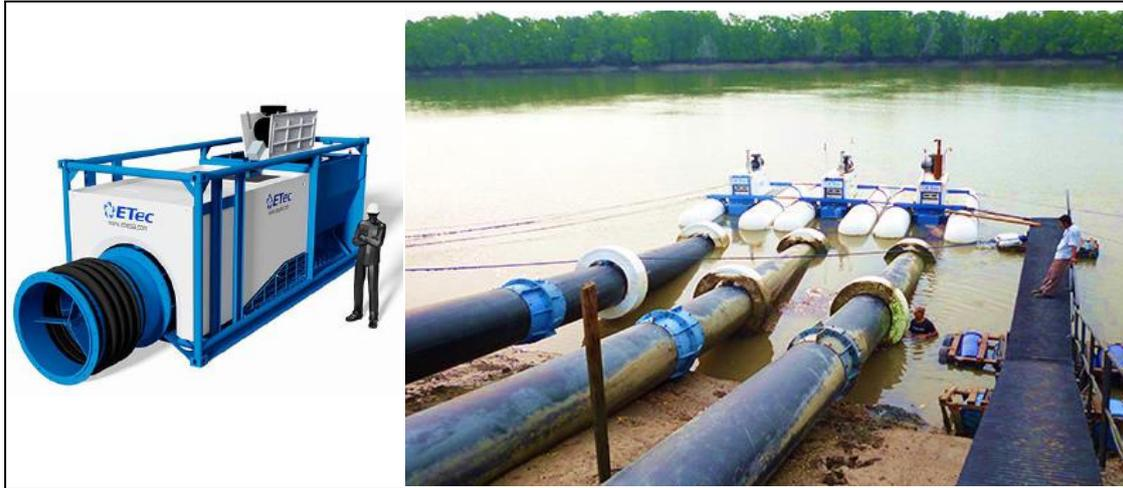
Figura 9 – Exemplo de bomba hidráulica utilizada numa fazenda de aquicultura marinha em Choluteca, Honduras. O empreendimento tem capacidade total de bombeamento superior a 263 m<sup>3</sup>/s. Fonte: ETEC S.A. Consultancy Services ([www.etcса.com](http://www.etcса.com)).
