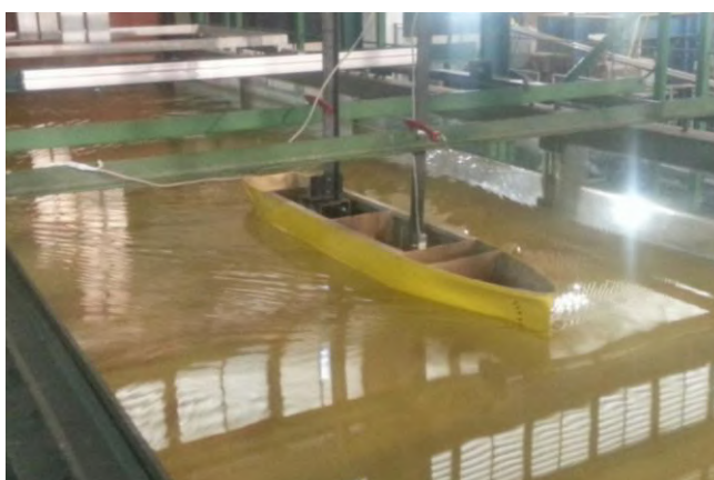
Figura 29 - Modelo da embarcação montado no canal de ensaios
