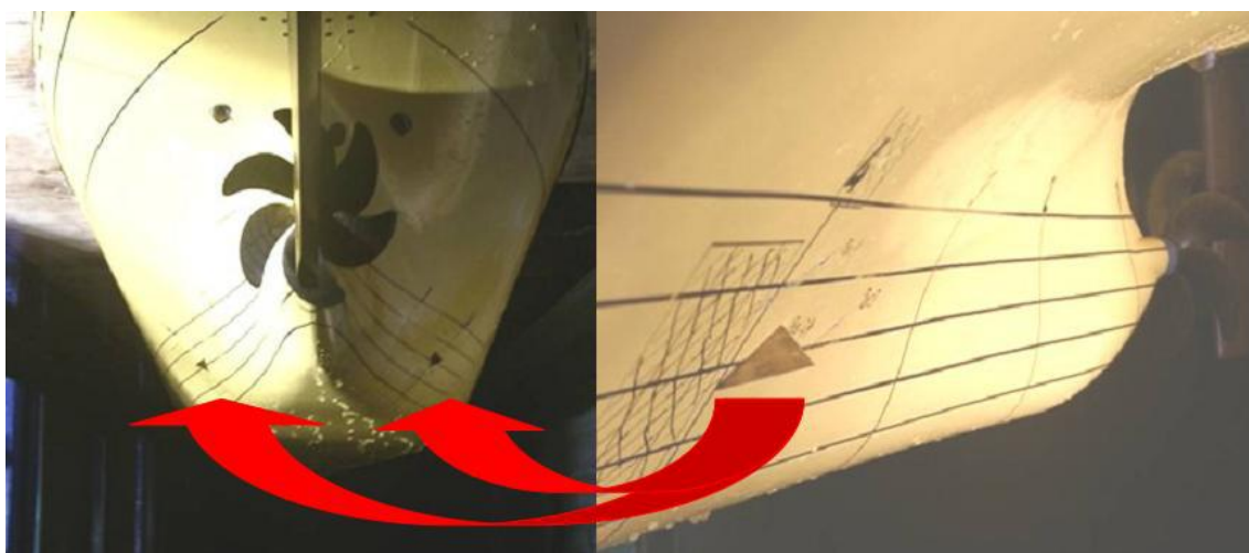
Figura 5: Geometria dos defletores transversais (Ref.[4])
