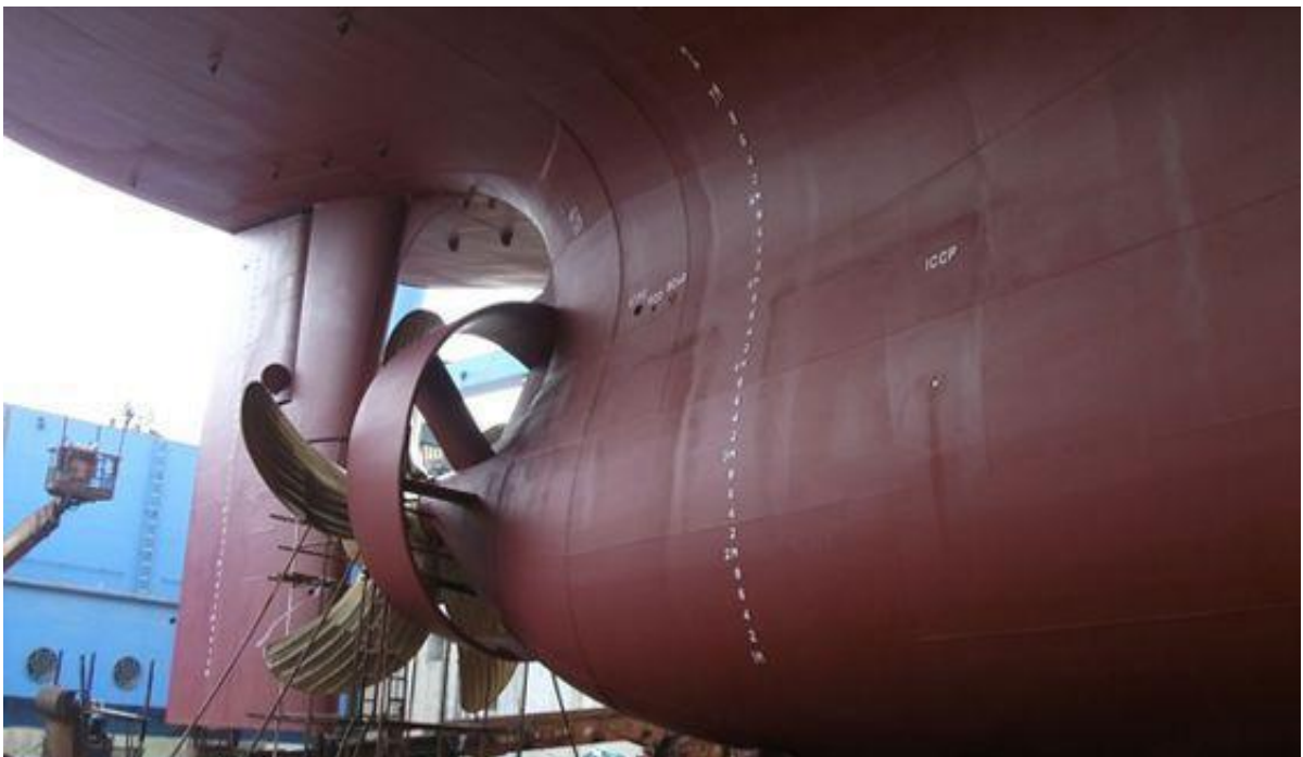
Figura 1: ESD a montante do propulsor. Fonte: Becker Marine Systems [20]
