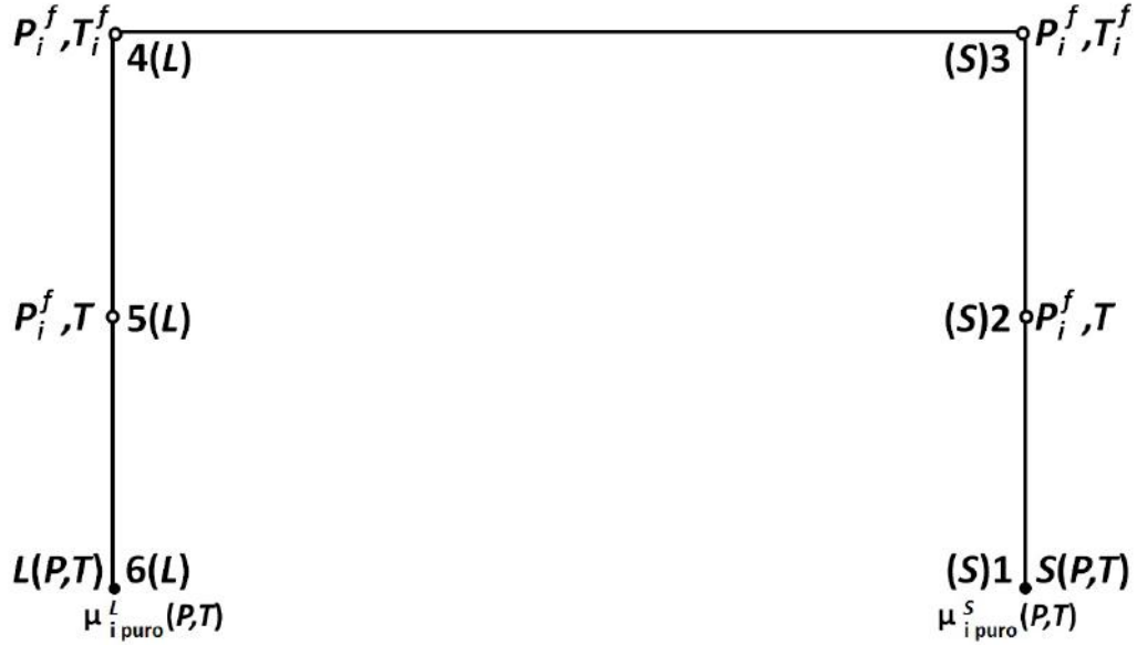
Figura 2.1: Diagrama para o cálculo do potencial químico do componente i puro na fase sólida. em que T_i^f e P_i^f são temperatura e pressão de fusão do componente i , respectivamente. Adaptado de FIROOZABADI (1999).
