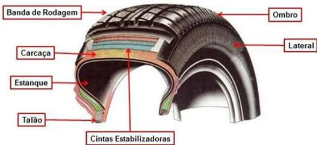
Figura 2.1: Esquema ilustrativo da estrutura de um pneu.
