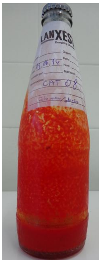
Figura 3.10: Iniciador IDVB-5 sintetizado a 25 °C, 10 % em peso de solução DVB em ciclohexano, razão molar DTHFP/ n -BuLi de 0,6 e armazenado a -15 °C.
