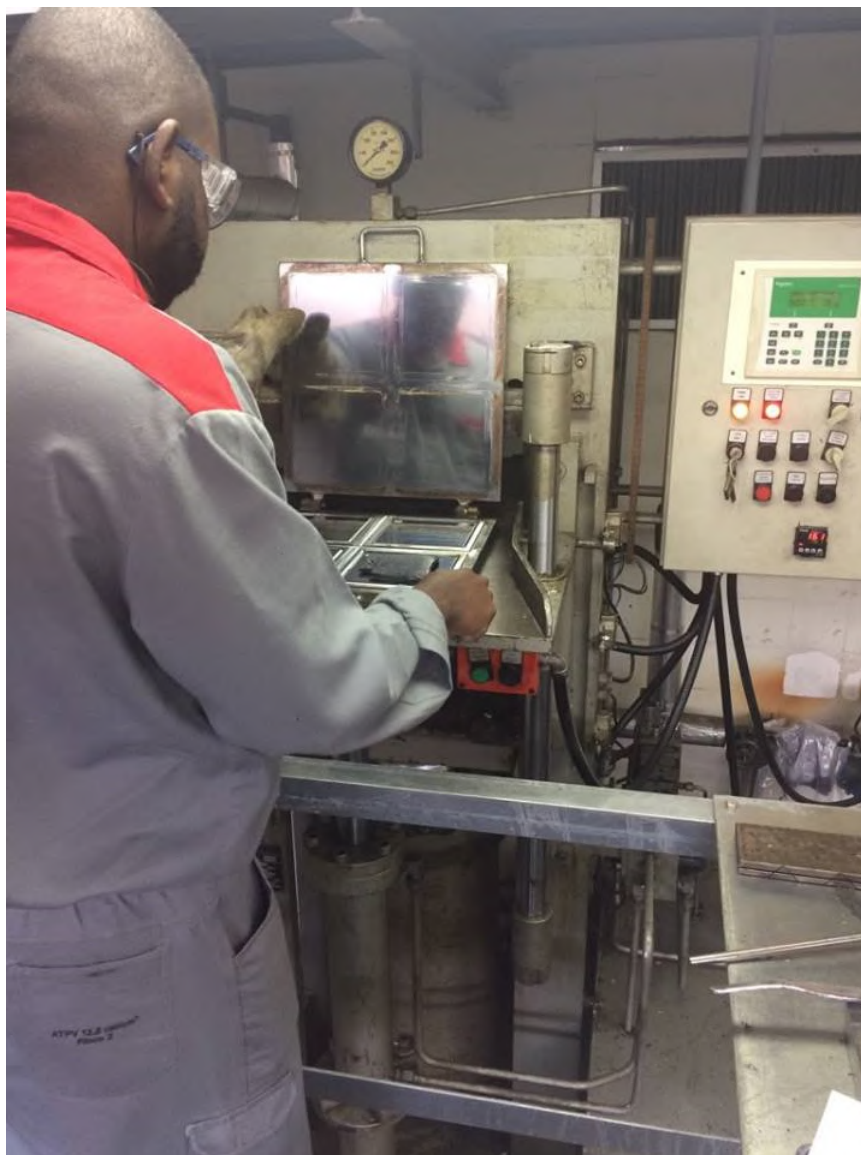
Figura 6.11: Equipamento utilizado para a vulcanização das borrachas.
