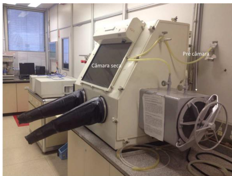
Figura 3.4 – Câmara seca para carregamento do catalisador e bio-óleo no reator.
