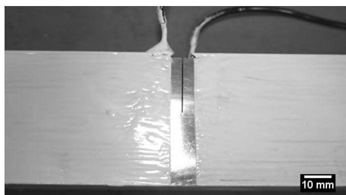
Figura 70 – Corpo de prova com revestimento polimérico, mostrando a região do entalhe que será exposta ao meio agressivo.
