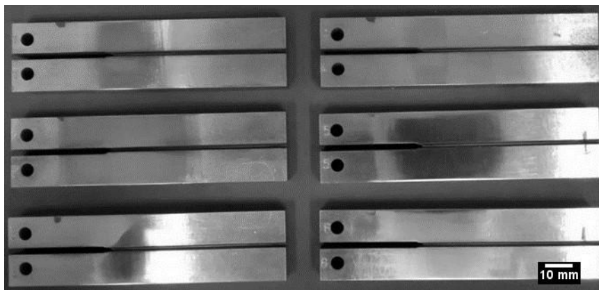
Figura 46 – Corpos de prova em geometria DCB.
