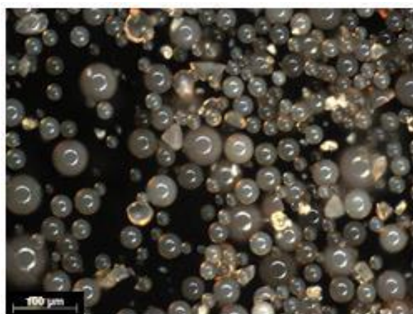
Figura 9: Micrografias de microscopia óptica para resina DVBS5, sulfonada por 24 horas.
