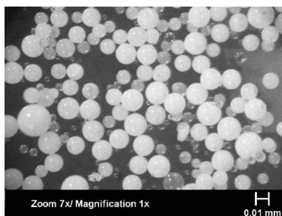
Figura 1: Micrografia de microscopia óptica das pérolas da resina STY-DVB, classificada como porosa e com elevada área superficial devido ao aspecto leitoso (AVERSA, 2011).
