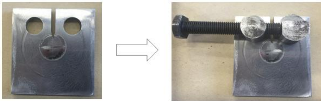
Figura 5.24: Corpo de prova com dispositivo para controle de abertura da trinca de fadiga.
