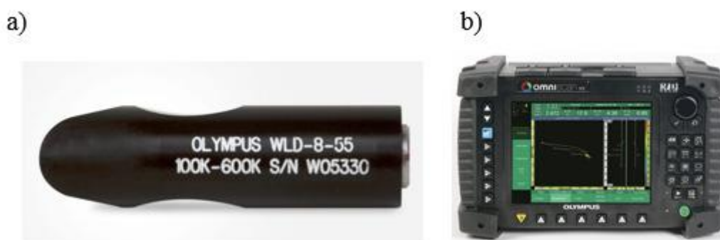
Figura 5.8: a) Sonda de correntes parasitas com configuração ortogonal utilizada para inspeção do corpo de prova fabricado e b) Equipamento de correntes parasitas Omniscan MX ECA da Olympus.
