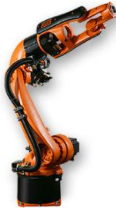
Figura 4.7: KUKA KRC4 – HW, fotografia do braço robótico a ser utilizado para assistir os ensaios com diferentes velocidades.
