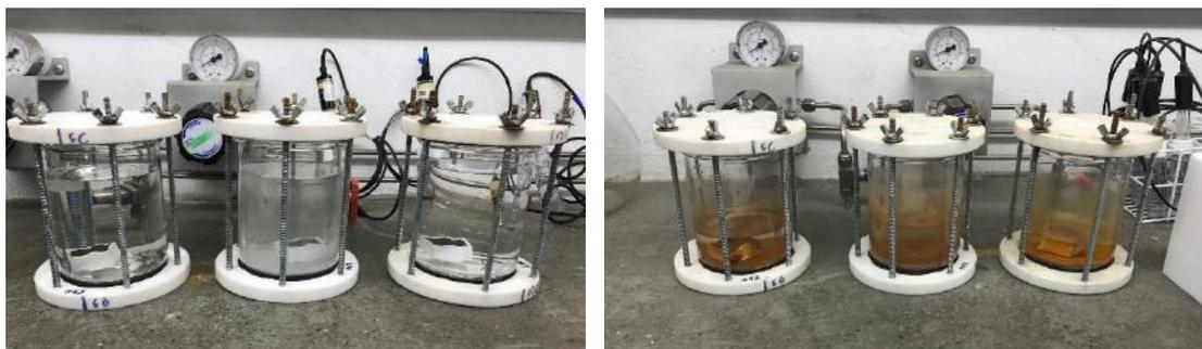
*Figura 37: Esquema de montagem do ensaio de avaliação da corrosão do aço no início (esquerda) e ao final (direita) do mesmo*
