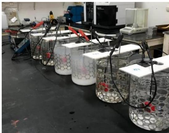
*Figura 42: Montagem do ensaio de verificação da qualidade do revestimento*
