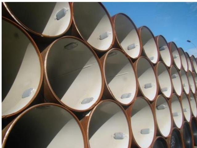
*Figura 23: Anodos internos instalados em tubos (autor)*
