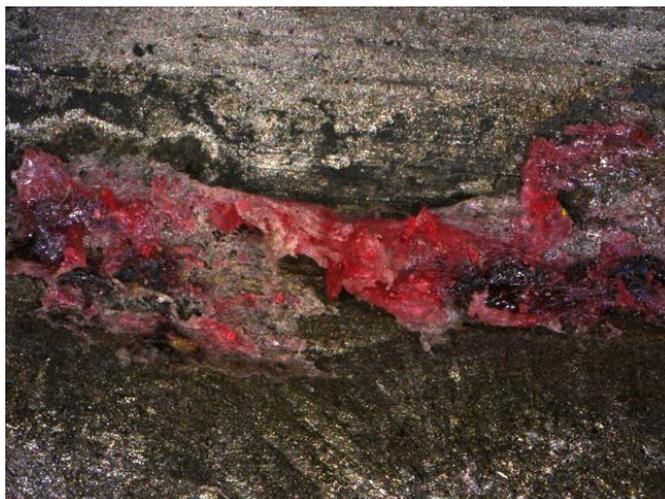
*Figura 67: Detalhe da superfície do CP imerso no meio 3*
