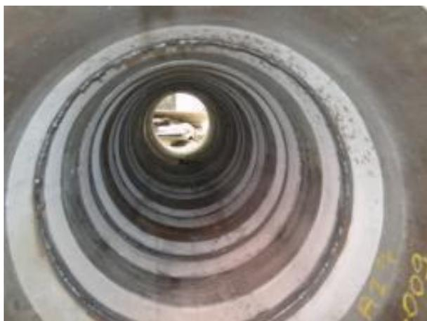
*Figura 24: Anéis de tubo soldados*
