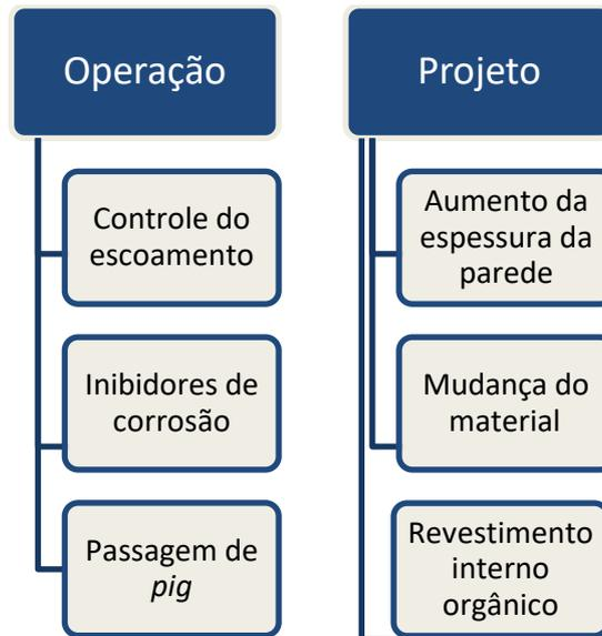
Figura 17: Medidas de prevenção de corrosão no interior de tubulação
