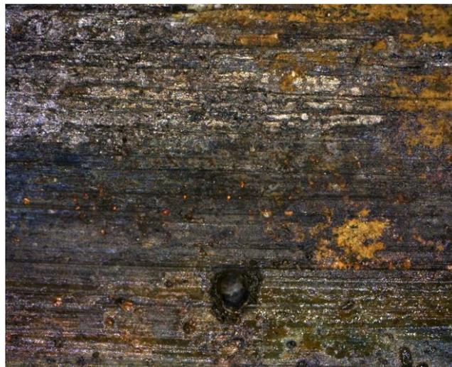
*Figura 66: Detalhe da superfície do CP imerso no meio 2*
