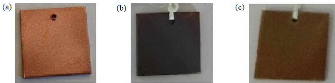
Figura 6.14 – Fotografias dos corpos de prova de cobre. (a) antes da imersão; (b) após 72 h de imersão em solução de KCl 0,1 \text{ mol.dm}^{-3} , \text{pH} = 6,0 ; (c) após 72 h de imersão em Imid 0,001 \text{ mol.dm}^{-3} , \text{pH} = 8,3 .
