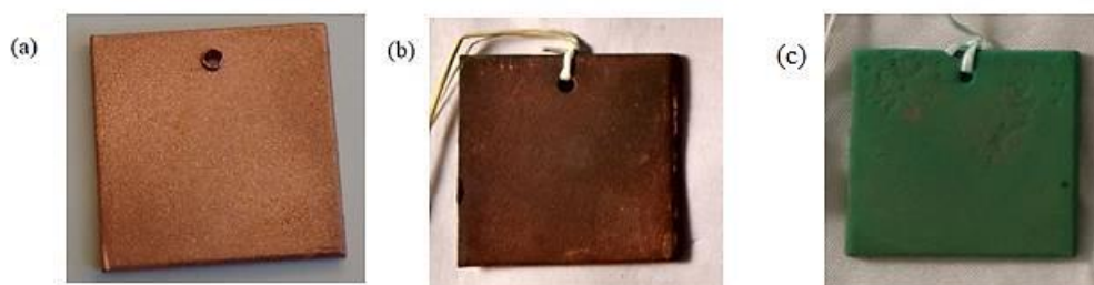
Figura 6.27 – Fotografias dos corpos de prova de cobre submetidos a diferentes tempos de imersão em solução de 4-MeImid 0,001 \text{ mol.dm}^{-3} , \text{pH} = 8,8 . (a) antes da imersão; (b) 24 h; (c) 72 h.
