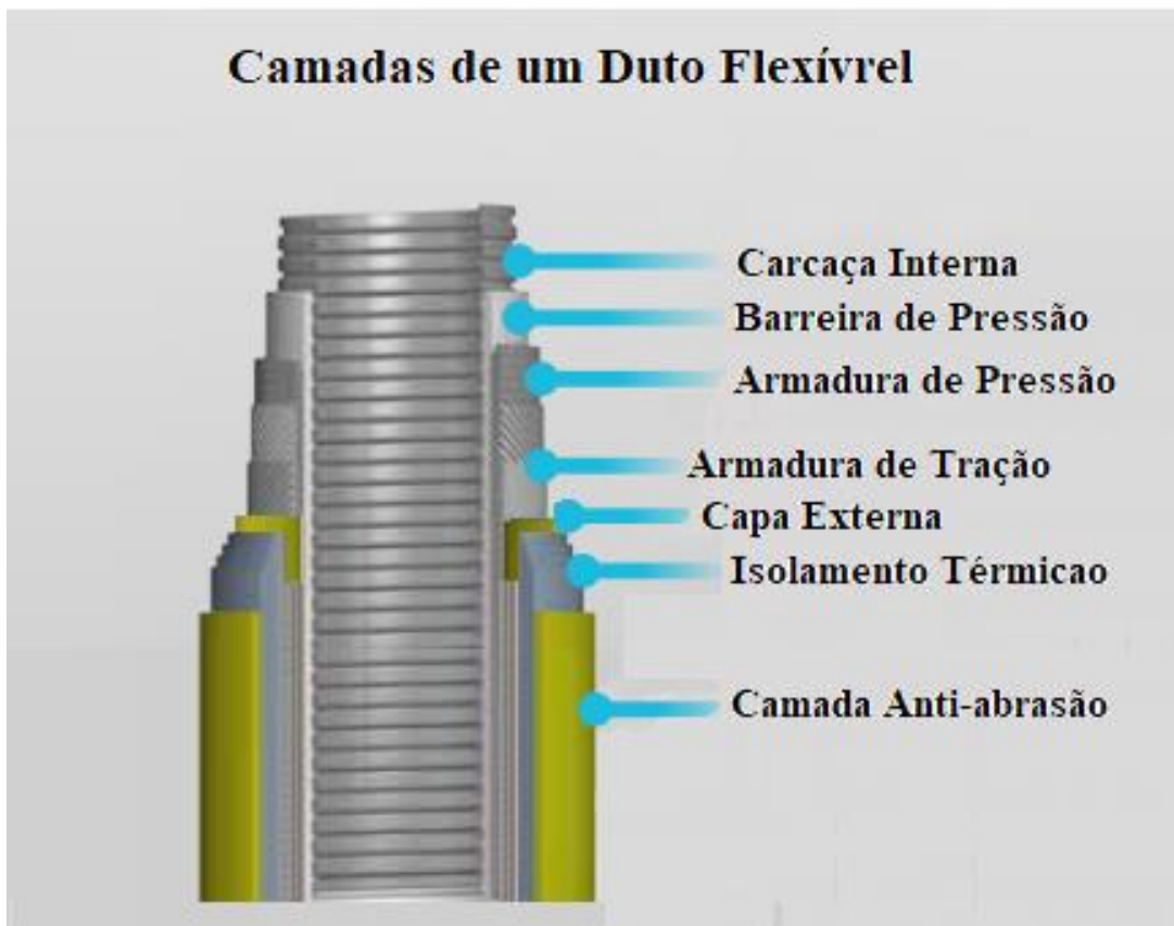
Figura 3-1 Configuração usual de um duto flexível. Adaptado de [5].
