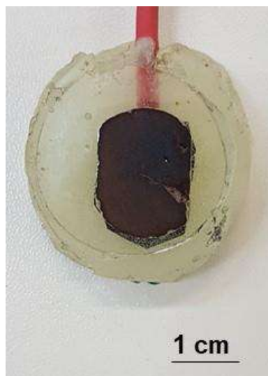
Figura 92. Fotografia da superfície da liga \text{Fe}_{26}\text{Cr}_{27}\text{Cu}_{16}\text{Al}_{31} após o ensaio de polarização potenciodinâmica.
