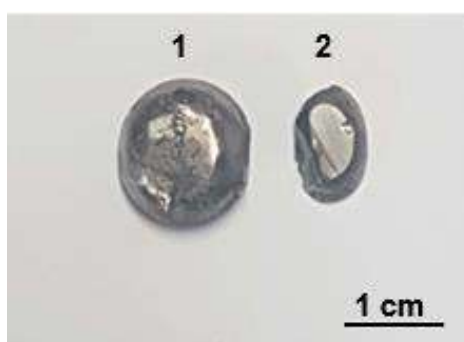
Figura 41. (1) Lingote fundidos resultantes do processo de fusão da liga \text{Fe}_{15}\text{Cr}_{15}\text{Nb}_{18}\text{Ni}_{27}\text{Al}_{25} (2) parte que ficou separada.
