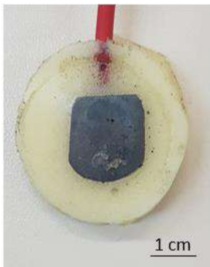
Figura 90. Fotografia da superfície da liga \text{Fe}_{16}\text{Cr}_{16}\text{Nb}_{16}\text{Zr}_{25}\text{Sn}_{27} após o ensaio de polarização potenciodinâmica.
