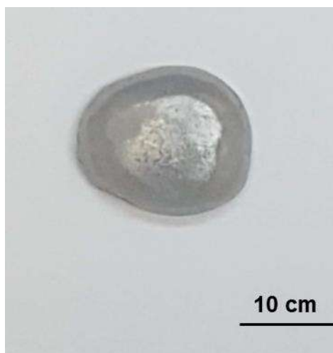
Figura 74. Lingote resultante da refusão da liga \text{Fe}_{16}\text{Cr}_{16}\text{Nb}_{16}\text{Zr}_{25}\text{Sn}_{27} .
