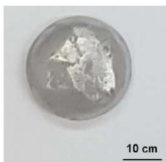
Figura 83. Lingote resultante do processo de fusão da liga \text{Fe}_{26}\text{Cr}_{27}\text{Cu}_{16}\text{Al}_{31} .
