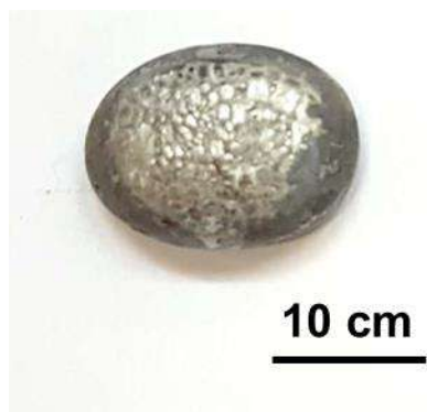
Figura 43. Lingote produzido durante o segundo processo de fusão da liga \text{Fe}_{15}\text{Cr}_{15}\text{Nb}_{18}\text{Ni}_{27}\text{Al}_{25} .
