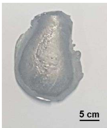
Figura 68. Lingote produzido durante o processo de fusão da liga \text{Fe}_{16}\text{Cr}_{16}\text{Nb}_{16}\text{Zr}_{25}\text{Sn}_{27} .
