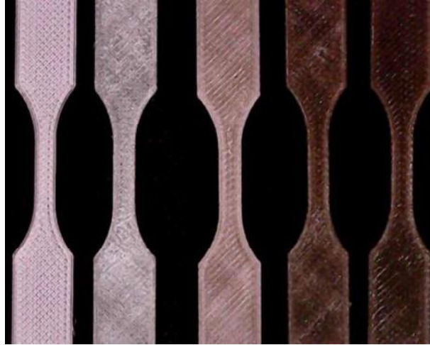
Figura 22: Fotografia dos corpos de prova de tração tipo V produzidos com os filamentos de PETG, PETR, PETR0, PETR3 e PETR5, respectivamente.
