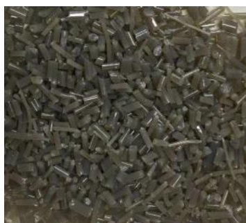
Figura 18: Pellets de PETR5 obtidos após primeiro processo de extrusão
