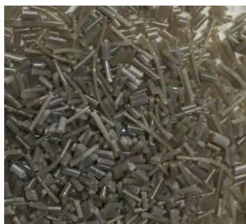
Figura 17: Pellets de PETR3 obtidos após primeiro processo de extrusão
