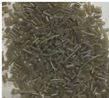
Figura 16: Pellets de PETR0 obtidos após primeiro processo de extrusão
