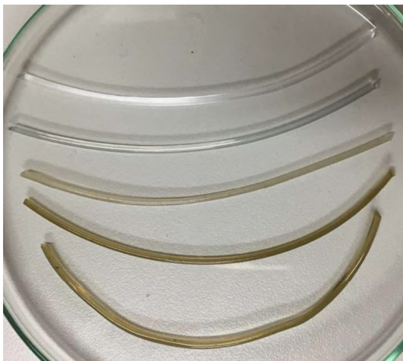
Figura 19: Comparação entre os filamentos. De cima para baixo, respectivamente, pedaços de filamentos de PETG, PETR, PETR0, PETR3 e PETR5
