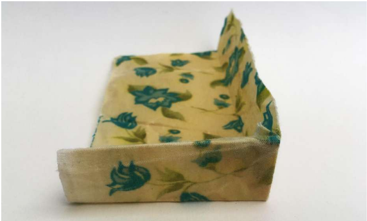
Figura 49 -Teste de dobra no tecido encerado (Fonte: Elaboração Própria)
