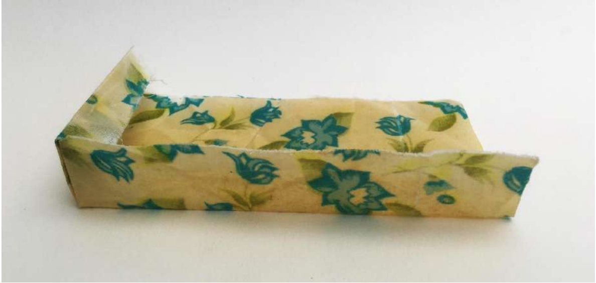
Figura 48 –Teste de dobra no tecido encerado (Fonte: Elaboração Própria)
