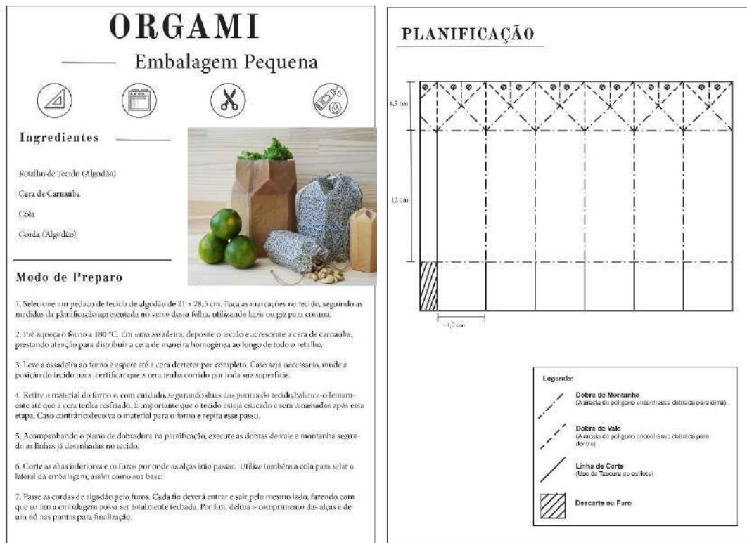
Figura 53 -Guia de Fabricação da embalagem (Fonte: Elaboração Própria)
