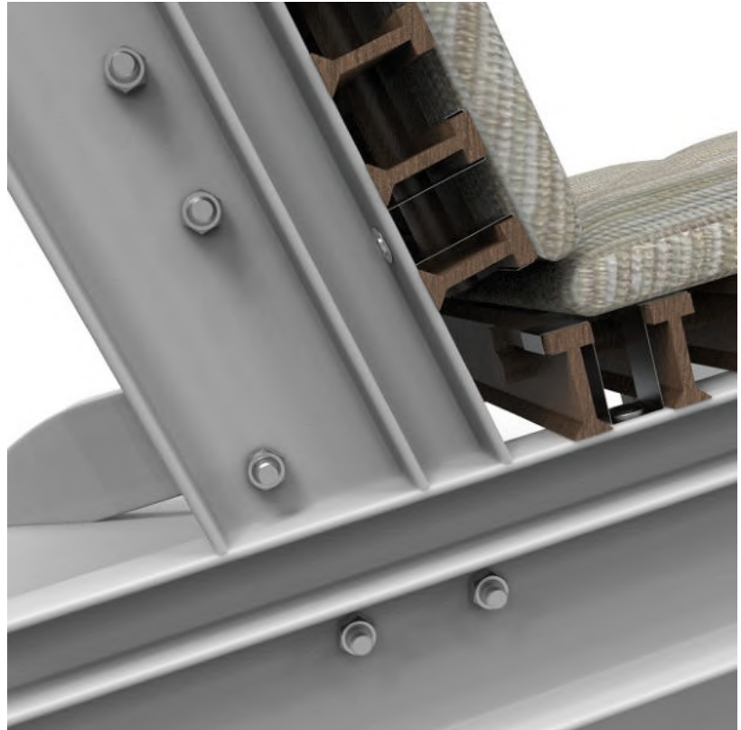
Figura 80 - Render do detalhamento das junções fixadas por parafusos. Fonte: (Elaboração própria)
