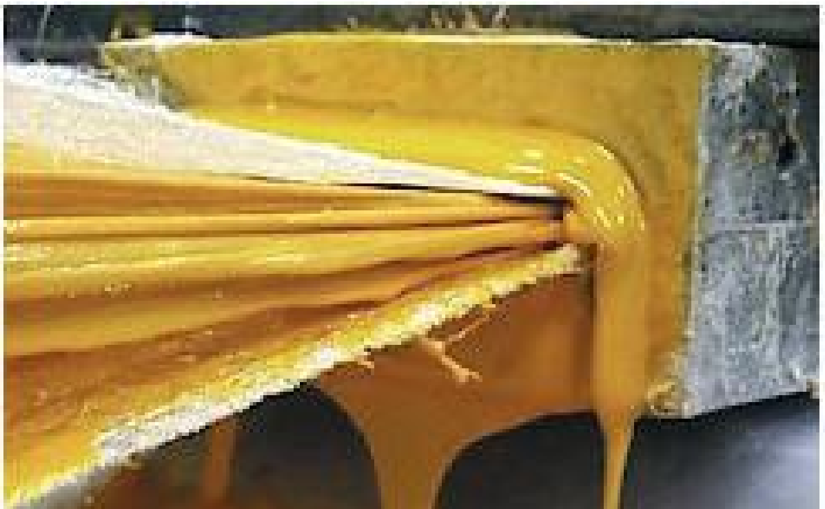
Figura 7 - Placa formada por fios e mantas impregnadas sendo puxadas para dentro do molde. Fonte: < http://www.fiberprofil.com/pt/pultrus-o/que-es/ >
