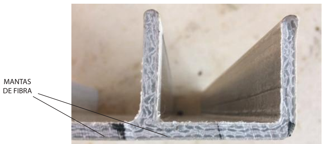
Figura 41 - Detalhe do perfil “E” com espessura de 0,5cm, cortado com as camadas de fibra à mostra. Fonte: (Elaboração própria)
