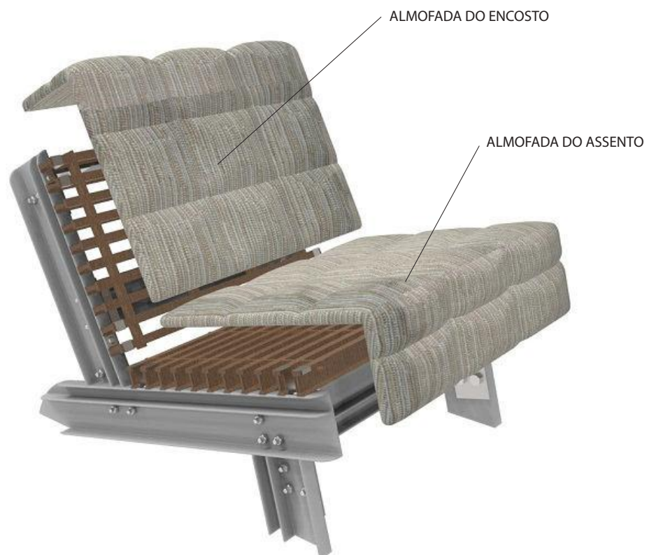
Figura 103 - Detalhamento da submontagem das almofadas. Fonte: (Elaboração própria)
