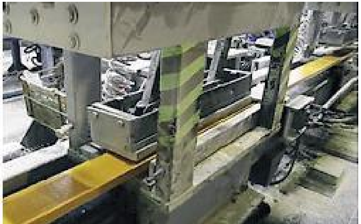
Figura 9 - O perfil pultrudado continua sendo puxado até ser submetido ao corte nas medidas desejadas. Fonte: < http://www.fiberprofil.com/pt/pultrus-o/-que-es/ >
