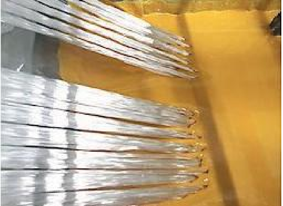
Figura 4 - Os fios de fibra são mergulhados em um tanque com resina, pigmento e catalisador. Fonte: < http://www.fiberprofil.com/pt/pultrus-o/que-es/ >
