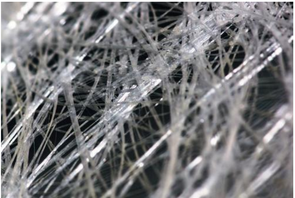
Figura 1 - Filamentos em fibra de vidro. Fonte: < https://www.infoescola.com/quimica/fibra-de-vidro/ >
