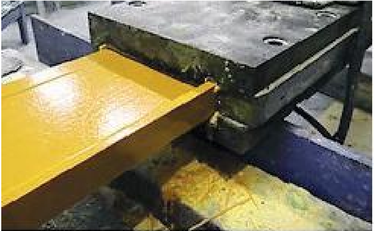
Figura 8 - Perfil devidamente curado pelo processo de polimerização. Fonte: < http://www.fiberprofil.com/pt/pultrus-o/-que-es/ >
