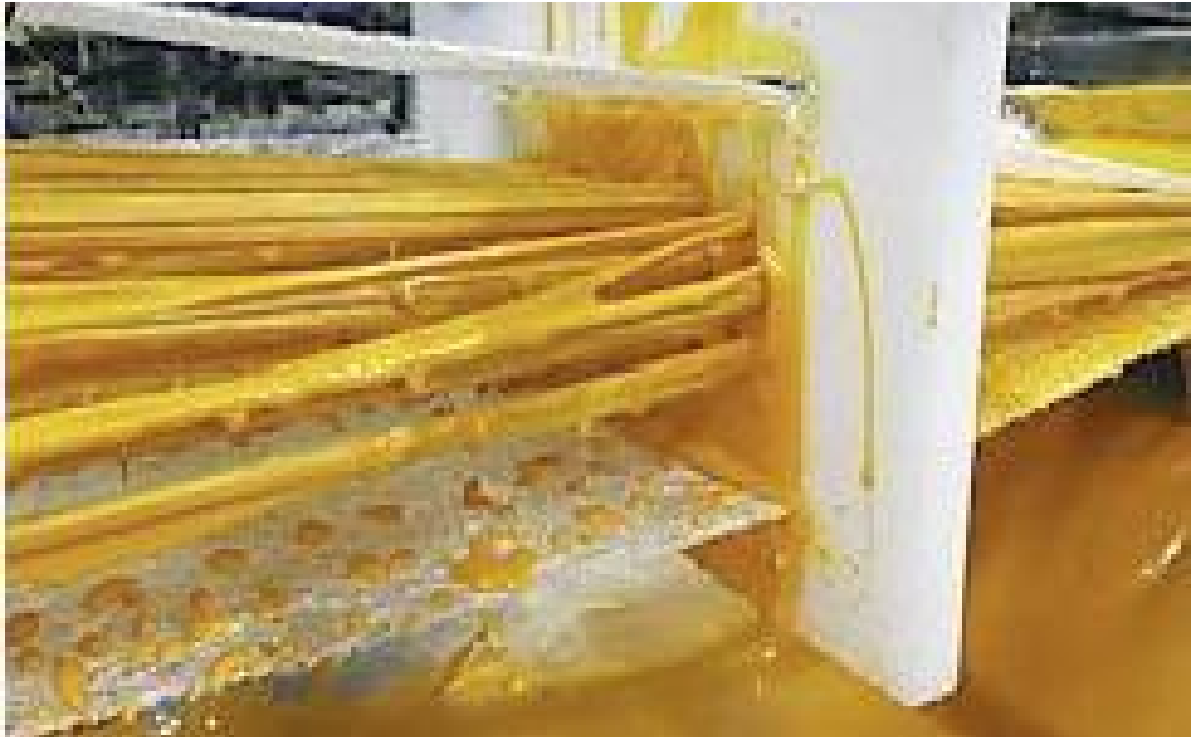
Figura 6 - Depois de banhados, os fios e as mantas passam por um dispositivo, onde são retirados os excessos e acrescentados véus de superfície. Fonte: < http://www.fiberprofil.com/pt/pultrus-o/que-es/ >
