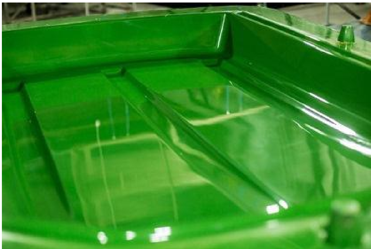
Figura 17 - Laminação em resina isoftálica. Fonte: < http://sccompositos.com.br/site/2017/09/08/os-problemas-que-podem-surgir-nos-processos-de-fabricacao-fiberglass/ >
