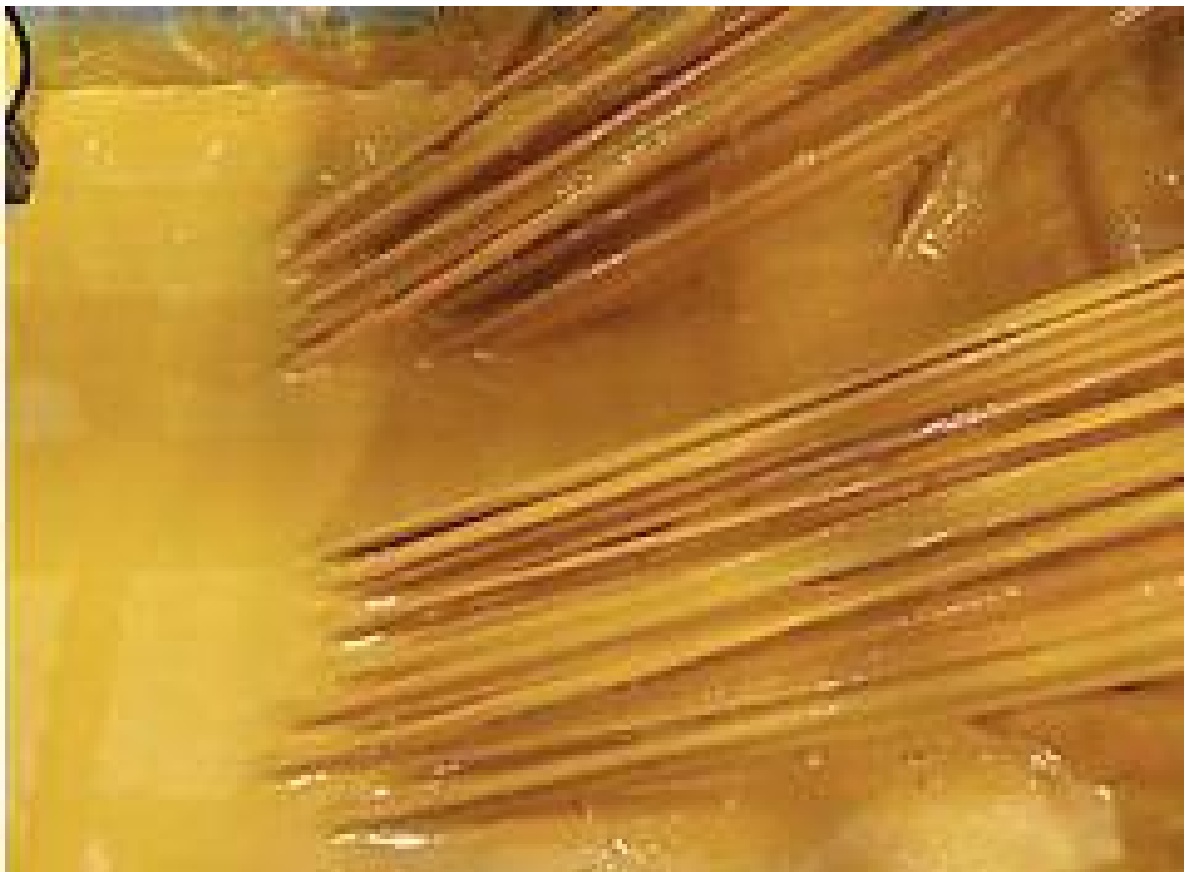
Figura 5 - Fios de fibra encharcados de resina. Fonte: < http://www.fiberprofil.com/pt/pultrus-o/que-es/ >
