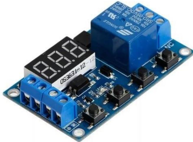
Figura 2.40 – Temporizador digital ajustável até 16 horas. Fonte: Mercado Livre.
