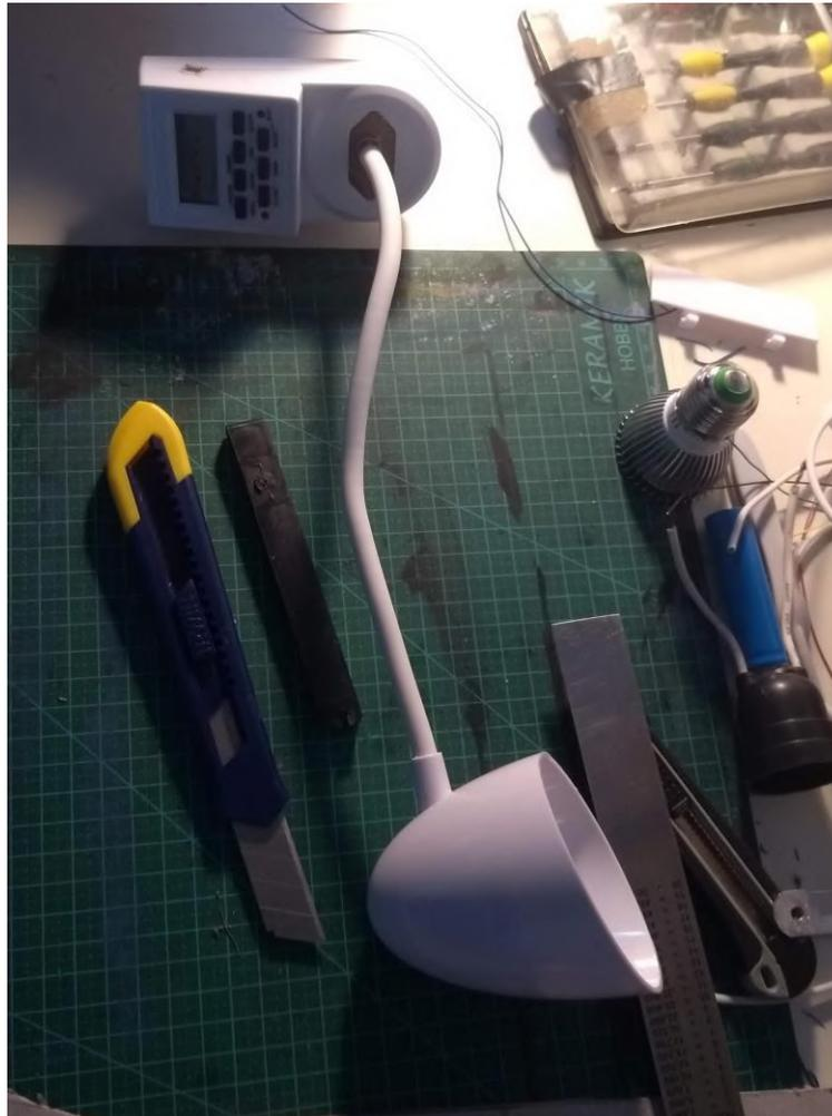
Figura 3.17 – Mock-up 5: Temporizador junto com luminária. Fonte: Elaboração própria.
