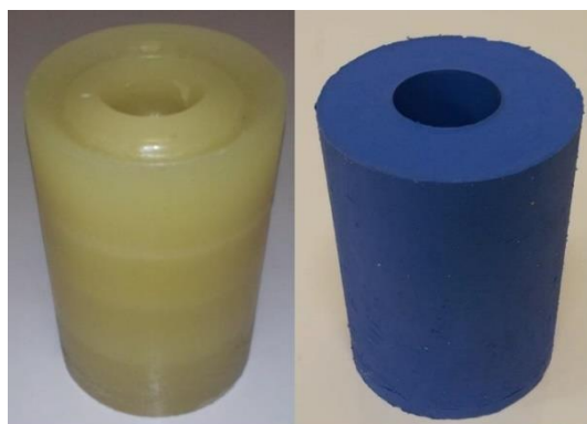
Figura 33: Cilindros de parafina (esquerda) e silicone (direita), usados na moderação de espectros de ^{241}\text{Am-Be} .
