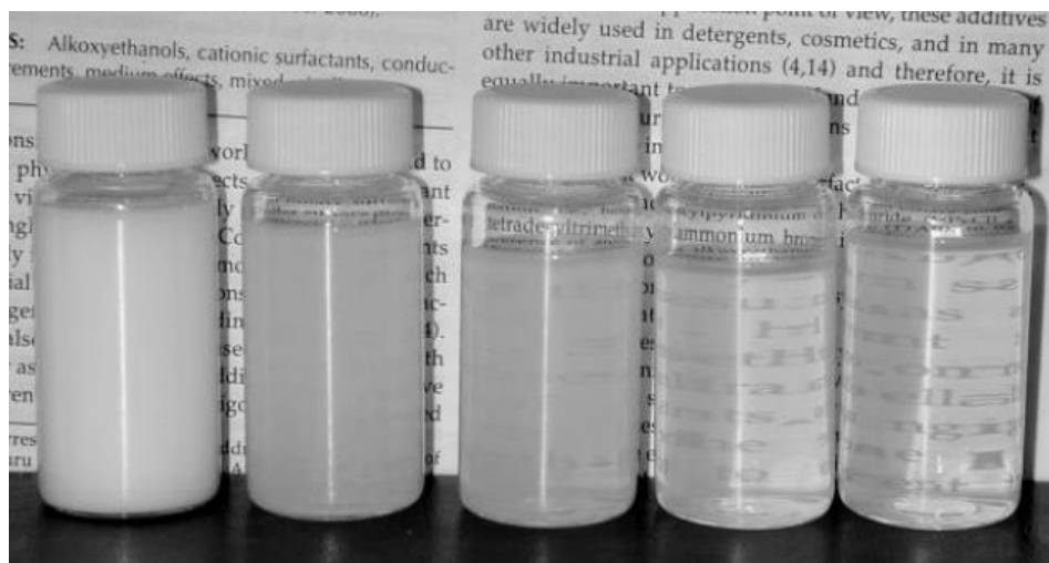
Figura 3. Variação da transparência de uma mesma composição em função do tamanho da fase dispersa. (SONNEVILLE-AUBRUN et al. , 2004).
