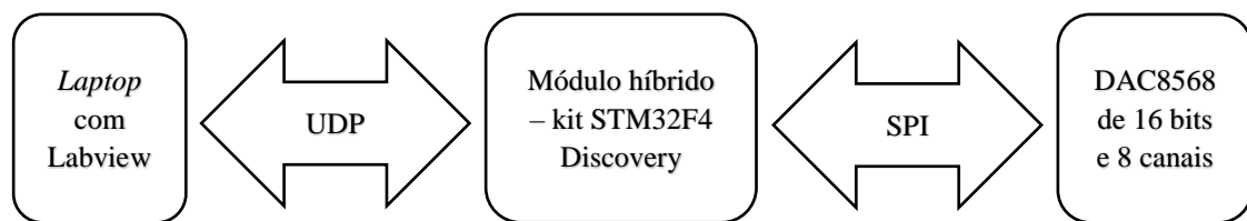
Figura 15 – Diagrama de blocos da interface do módulo híbrido com o estimulador elétrico.
