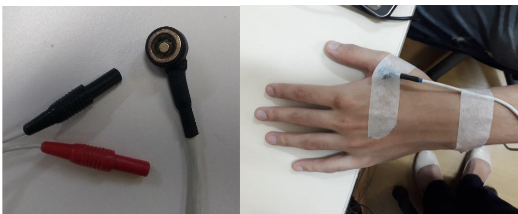
Figura 25 - Eletrodo utilizado para a estimulação elétrica e o posicionamento do mesmo no participante.
