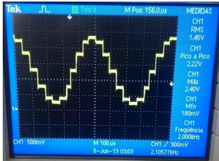
Figura 22 – Sinal analógico para o estimulador medido na saída do DAC. O sinal está na amplitude máxima de 8000 (correspondente a 8 mA na saída do estimulador) e tem frequência de 2 kHz.
