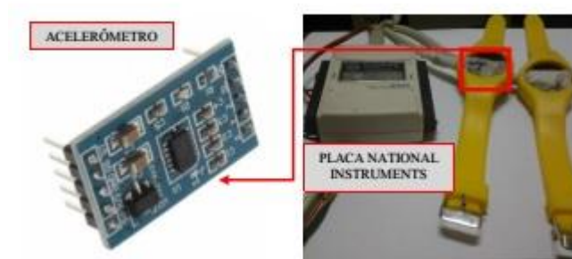
Figura 15. Acelerômetro tri-axial modelo MMA 7361 (Freescale, EUA) acoplado a um suporte, sob a forma de pulseira de relógio e conectado à Placa de aquisição da National Instruments (NI USB - 6009). (Adaptado de BRANCO, 2015)
