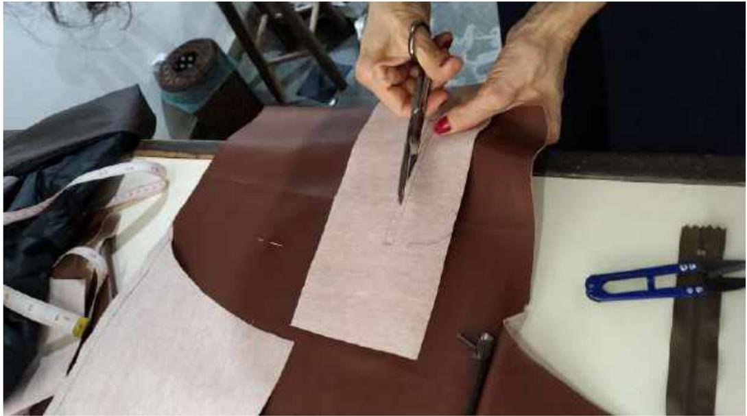
**Figura 96:** O material precisou ser cortado para que pudesse ser acoplado o forro embutido
