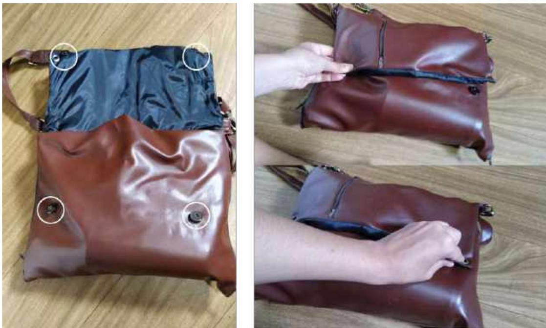
**Figura 110:** Passo a passo da montagem - Fechamento dos botões magnéticos
