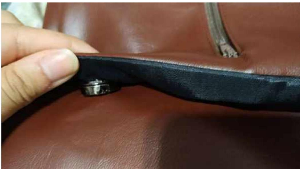
**Figura 103:** Botões magnéticos costurados aplicados com reforço, de forma que não danifica o nylon ao ser puxado
