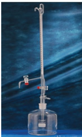
Figura 3.5: Bureta de vidro com escala graduada
