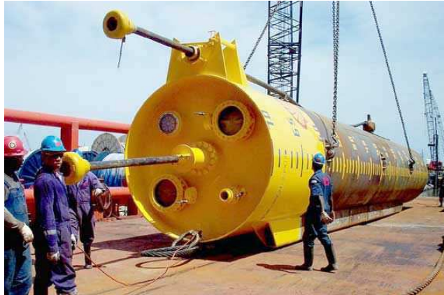
Figura 11 - Estaca de sucção(Aguiar, 2007)
