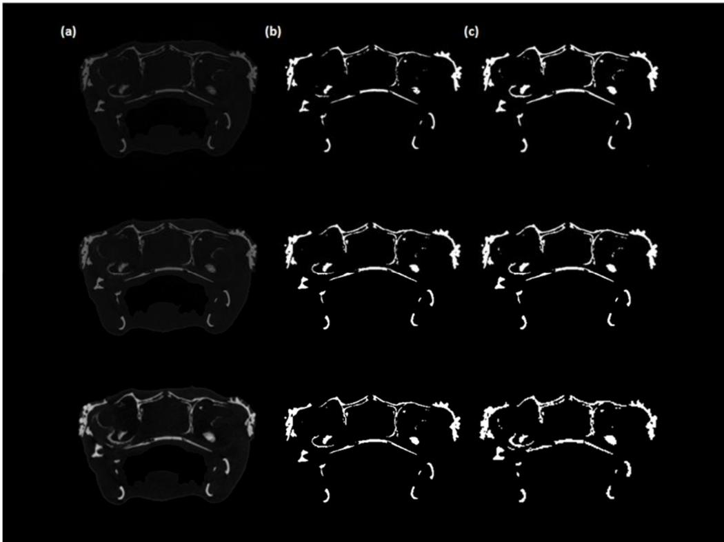
**Figura20 -** Imagens de cortes feitos na mesma posição da amostra. Menor tamanho de voxel está no topo e maior embaixo. Na coluna (a) estão os cortes das imagens originais, em escala de cinza; na coluna (b) estão os respectivos cortes segmentados pelo método Global; e em (c) os segmentados pelo método Otsu.
