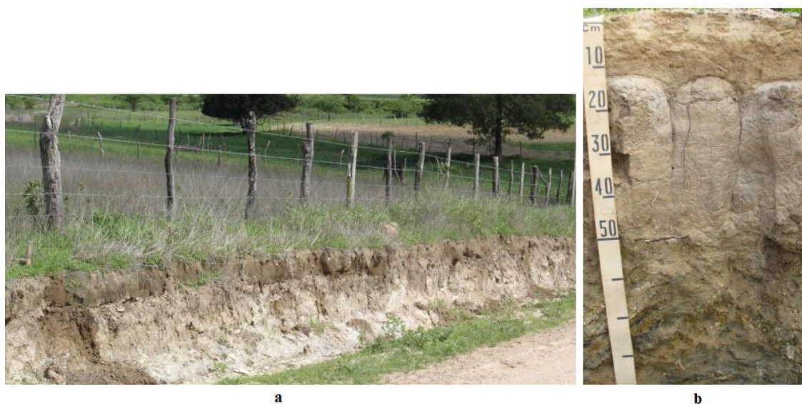
Figura 2.14 A figura da esquerda (a) mostra a região típica de ocorrência de um Planossolo e a figura da direita (b) o perfil típico desse solo, adaptado de (EMBRAPA, 2014)
