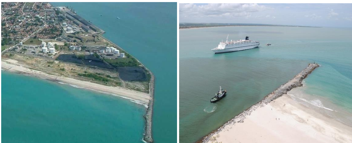
Figura 2. Imagens aéreas da praia de Miramar, com foco no guia-correntes localizado na margem direita do estuário do rio Paraíba do Norte (PARAÍBA CRIATIVA, 2005)
