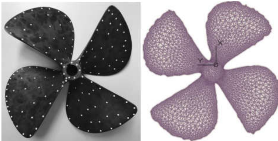
Figura 5.6. Levantamento da geometria do propulsor.
