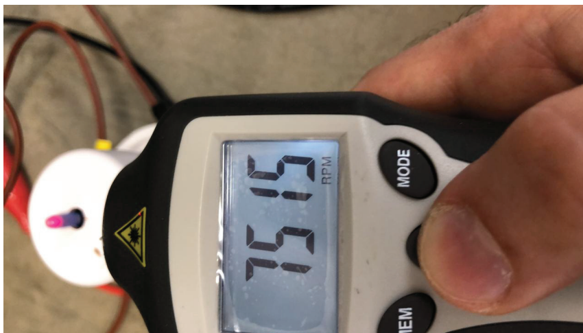
Figura 2.7: Tacômetro medindo RPM do motor.
