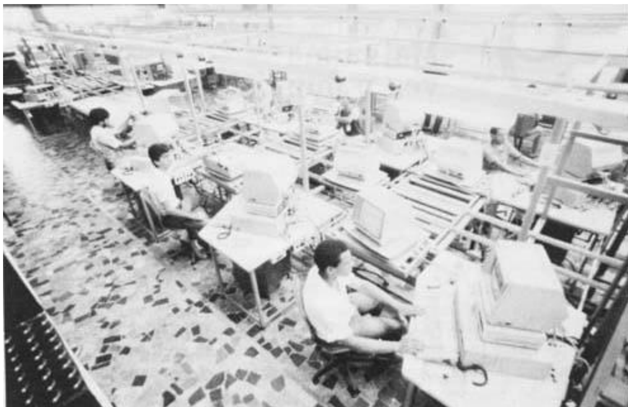
Unidade de integração de Mutinga II (Scopus): notar os microcomputadores com os quais os operários testam os equipamentos recém-montados.
