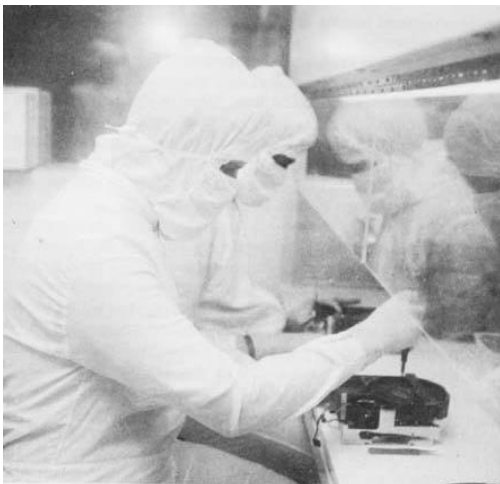
Operárias montam unidades de disco winchester na sala-limpa da Flexidisc.
