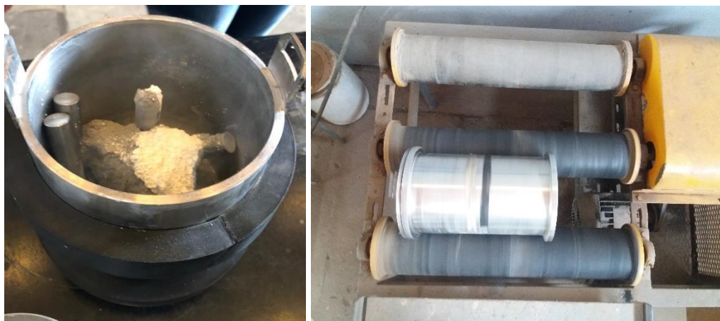
Figura 17 – A direita moinho utilizado na etapa de ativação mecanoquímica com 10% m/m de CaO (450g de amostra: 50 gramas CaO) e a esquerda a moagem a 75 r.p.m
