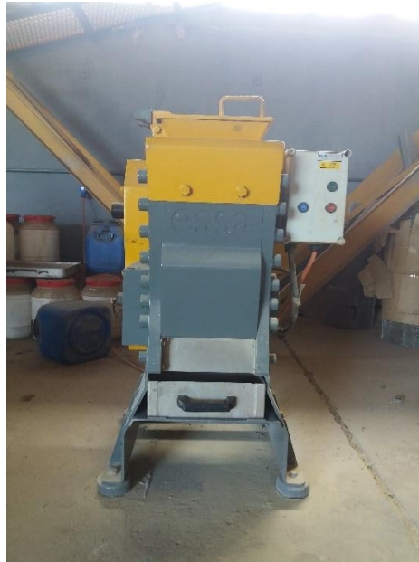
Figura 13- Britador de mandíbulas utilizado na etapa de britagem
