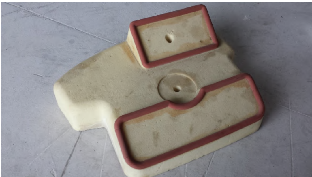
Figura 69 - Molde criado em poliuretano com a fresa para o painel do Reach Stacker.
