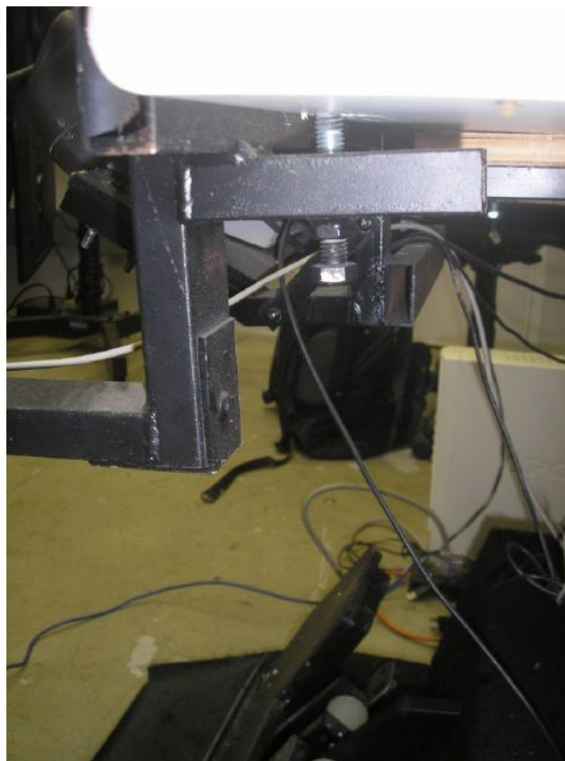
Figura 74 - Mordentes de metalon para fixação do painel a qualquer modelo de mesa.
