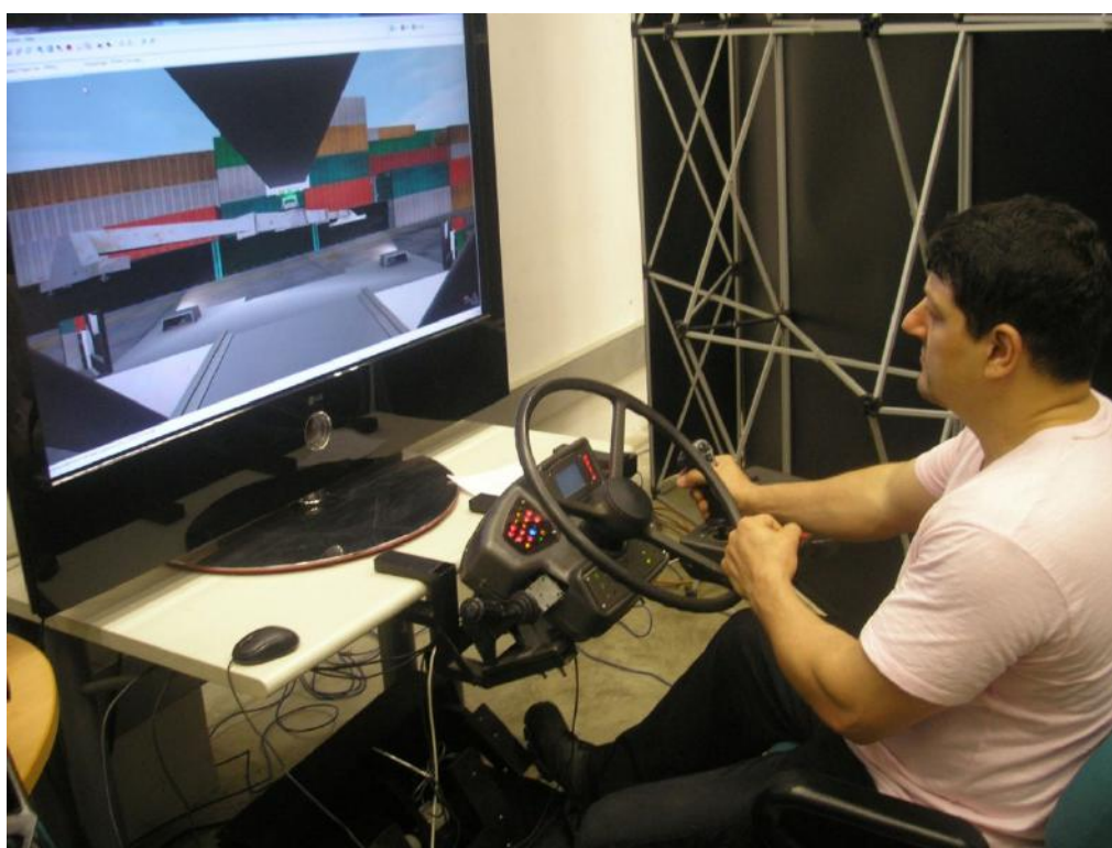
Figura 78 - Painel integrado ao software na execução das manobras do Reach Stacker.
