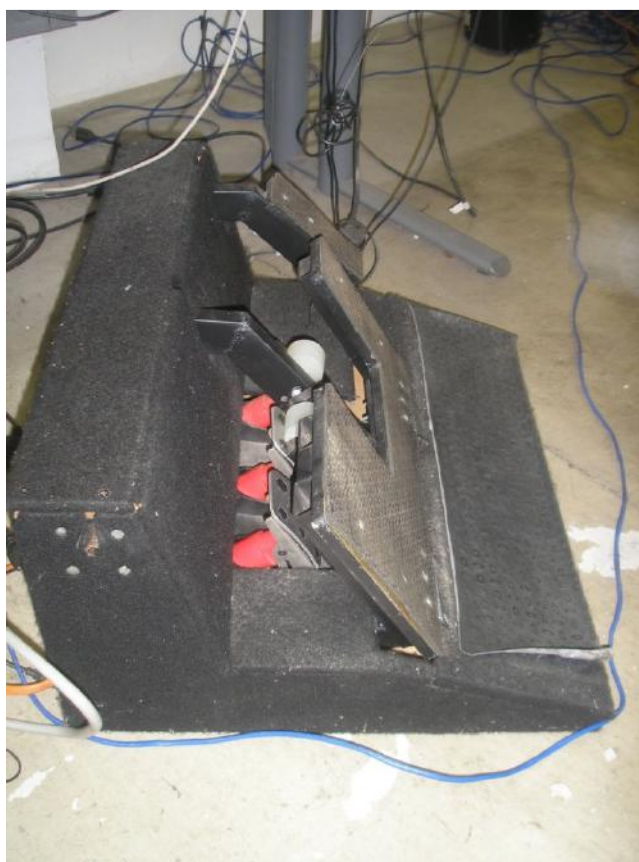
Figura 76 - Pedais adaptados do joystick G-25 da Logitech.
