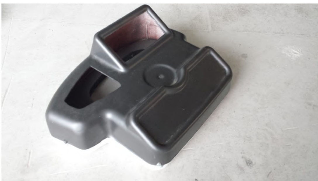
Figura 70 - Painel feito em poliestireno pelo processo de vacuum forming utilizando o molde fresado anteriormente.
