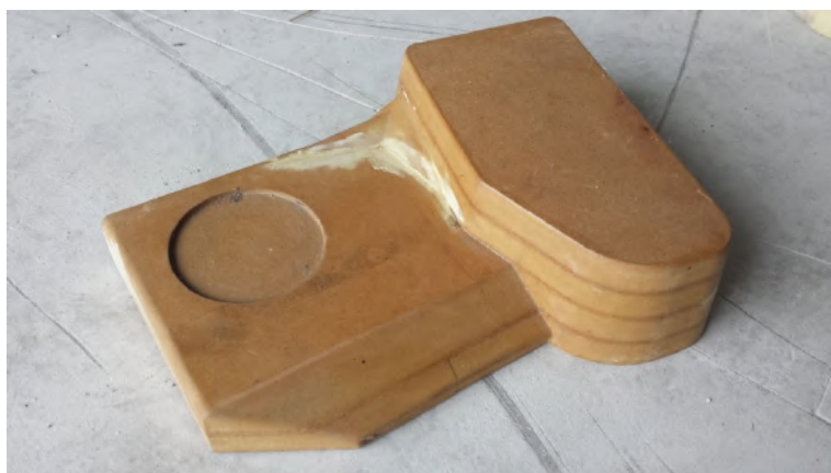
Figura 67 - Molde criado em MDF com a fresa para a base do joystick do Reach Stacker.
