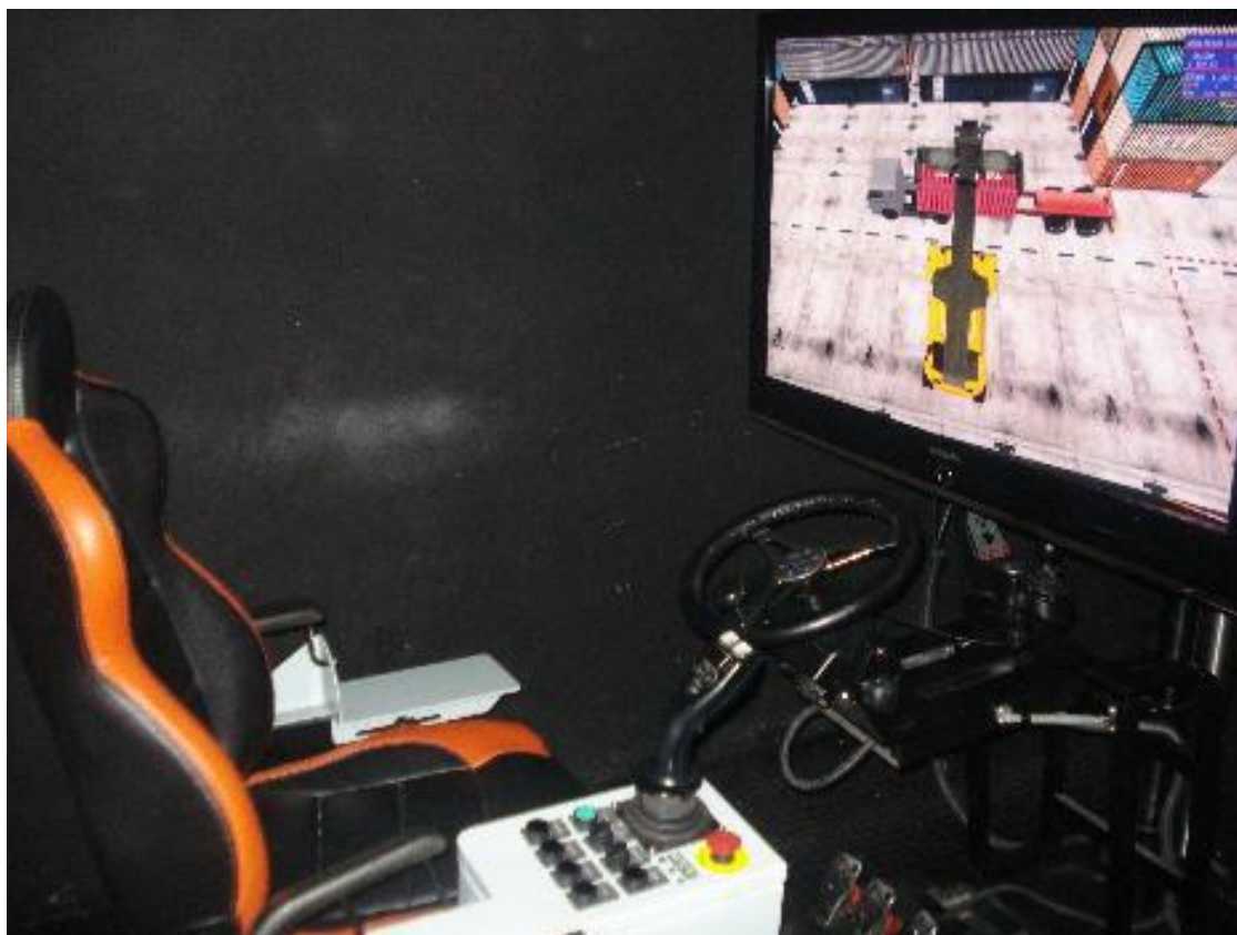
Figura 14 - Simulador de Reach Stacker desenvolvido pela LSyM.
