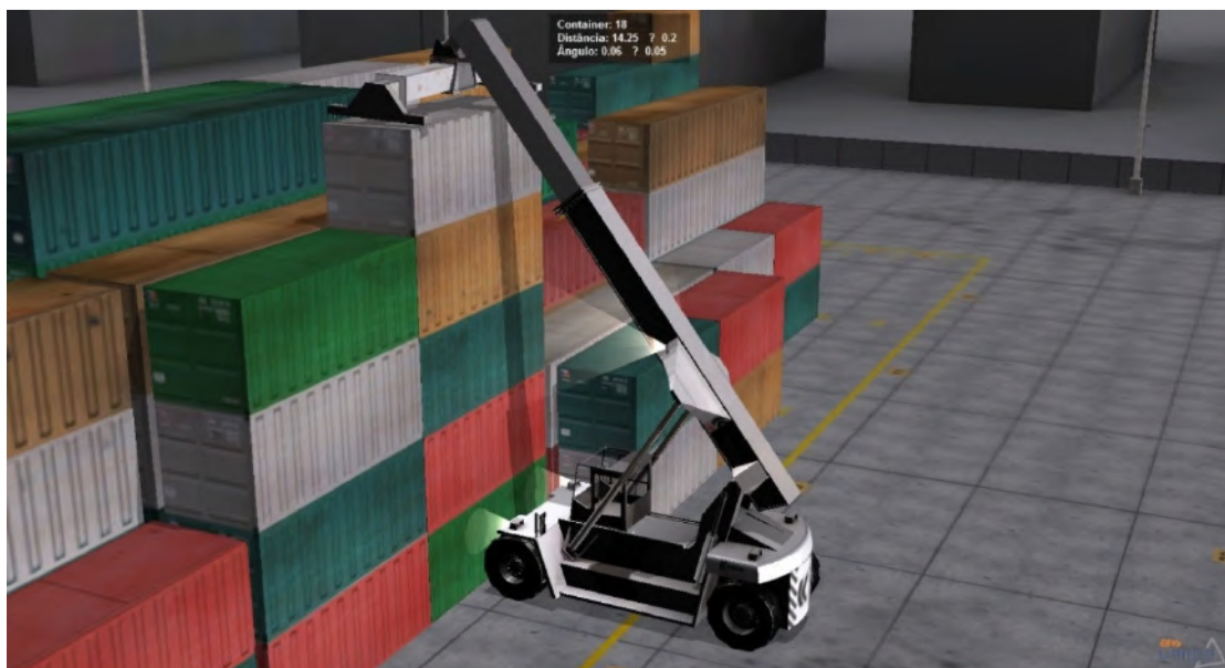
Figura 51 – Caixa de diálogo na parte superior com informações da distância e ângulo dos contêineres que podem ser engatados.
