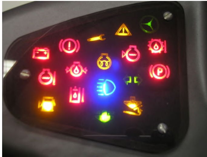
Figura 56 – Luzes do painel do simulador de Reach Stacker.
