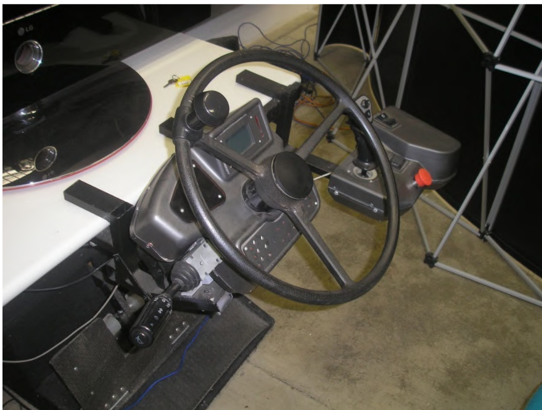
Figura 72- Painel e volante fixados na mesa por mordentes de metalon.
