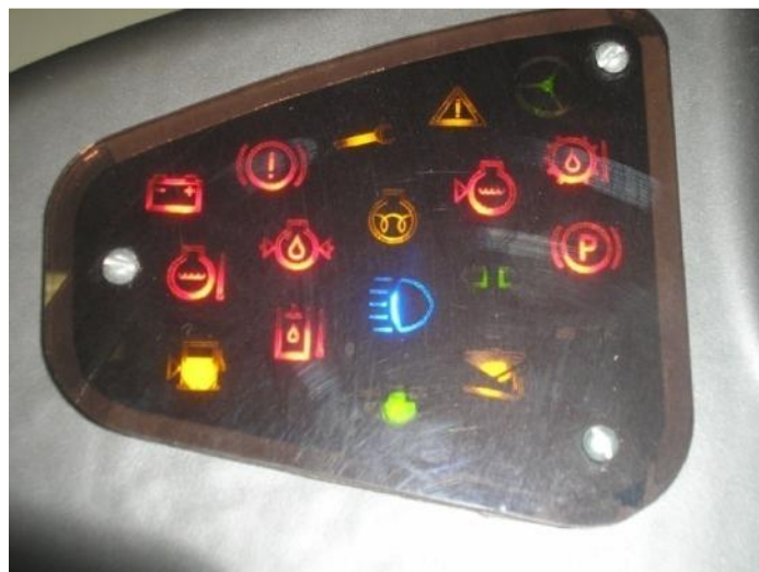
Figura 77 - Iluminação do painel utilizando Arduino e leds.
