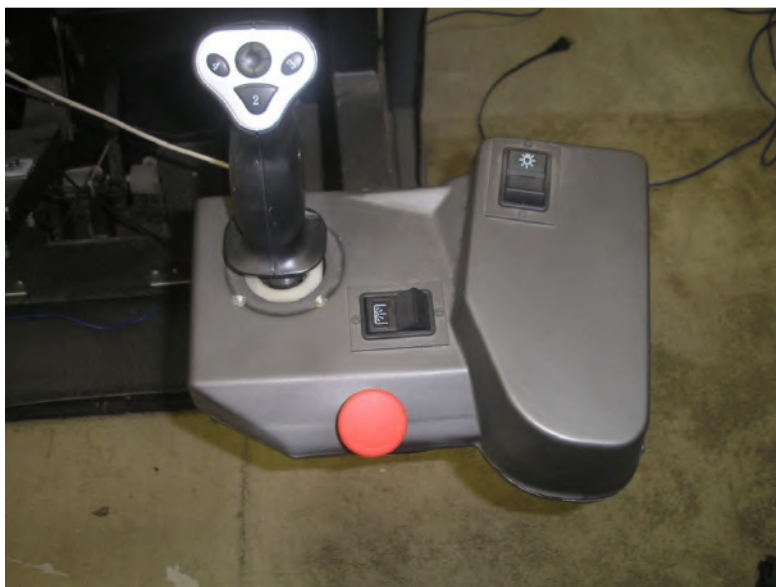
Figura 75 – Joystick para controle dos movimentos do spreader do Reach Stacker.
