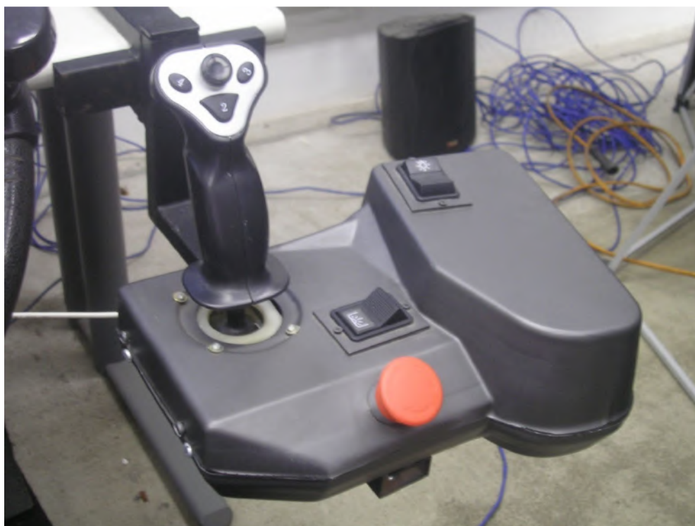
Figura 68 - Base do joystick do Reach Stacker moldada no poliuretano com o processo de vaccum forming utilizando o molde fresado anteriormente.
