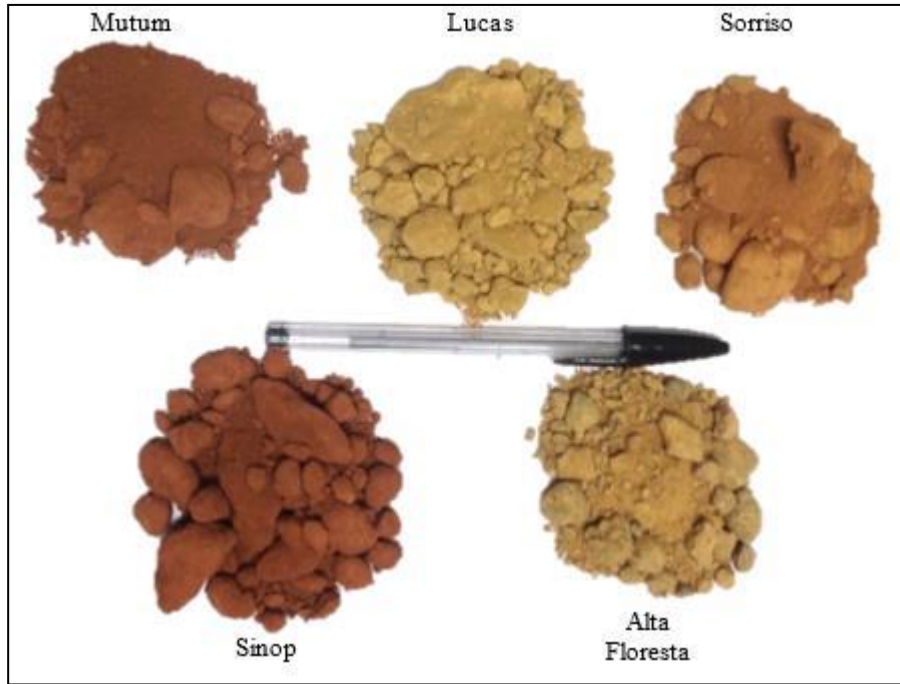
Figura 51 – Amostras das 5 lateritas utilizadas neste estudo
