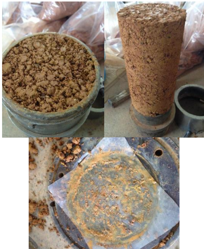
Figura 60 - Exsudação de água do corpo de prova da Laterita Lucas desta pesquisa
