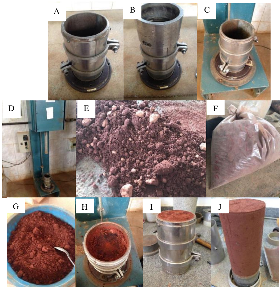
A – Molde tripartido montado; B – Molde tripartido com o colarinho; C e D – Molde tripartido posicionado no compactador automático; E – Solo homogeneizado; F – Amostra pronta para repouso na câmara úmida; G – Material após repouso em câmara úmida; H – Oitava camada de solo compactada; I – Corpo de prova compactado e rasado; J – Corpo de prova desmoldado.
