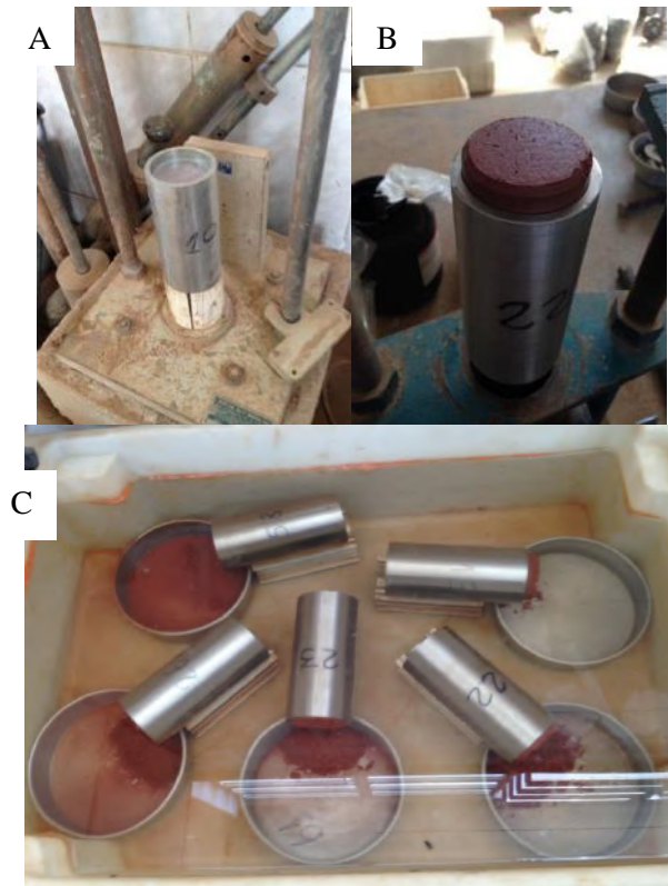
A – Corpo de prova preparado para ser compactado; B – Extração de 10 mm do corpo de prova compactado; C – Corpos de prova imersos. Figura 33 – Algumas etapas dos ensaios da classificação MCT realizados nesta pesquisa
