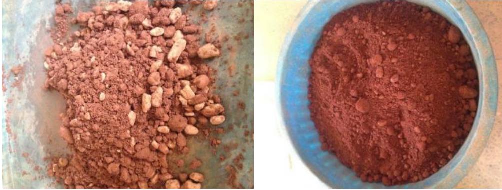
Figura 59 - Aspecto Laterita Mutum antes (esquerda) e depois do período de câmara úmida (direita)
