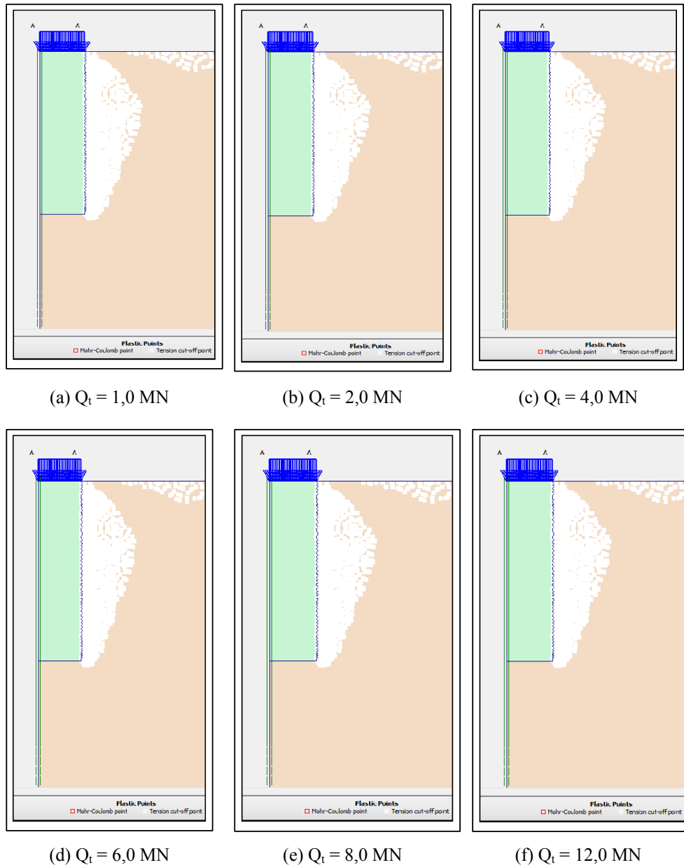
Figura 4.2 – Evolução da zona plastificada na interface da estaca com L/D = 2 e maciço com \sigma_{ci} = 15 \text{ MPa} - Fuste rugoso.
