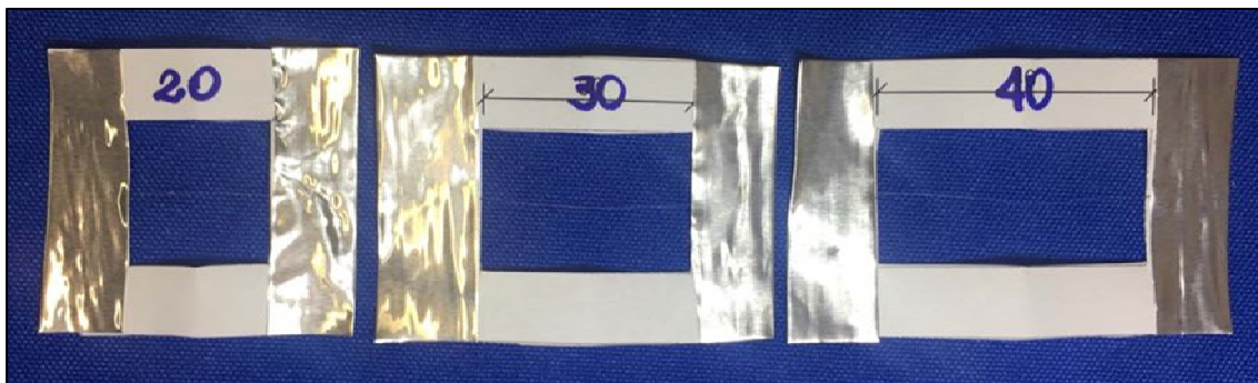
Figura 3.7: Moldes utilizados para a realização do ensaio de tração da fibra de juta nos comprimentos de 20, 30 e 40mm.
