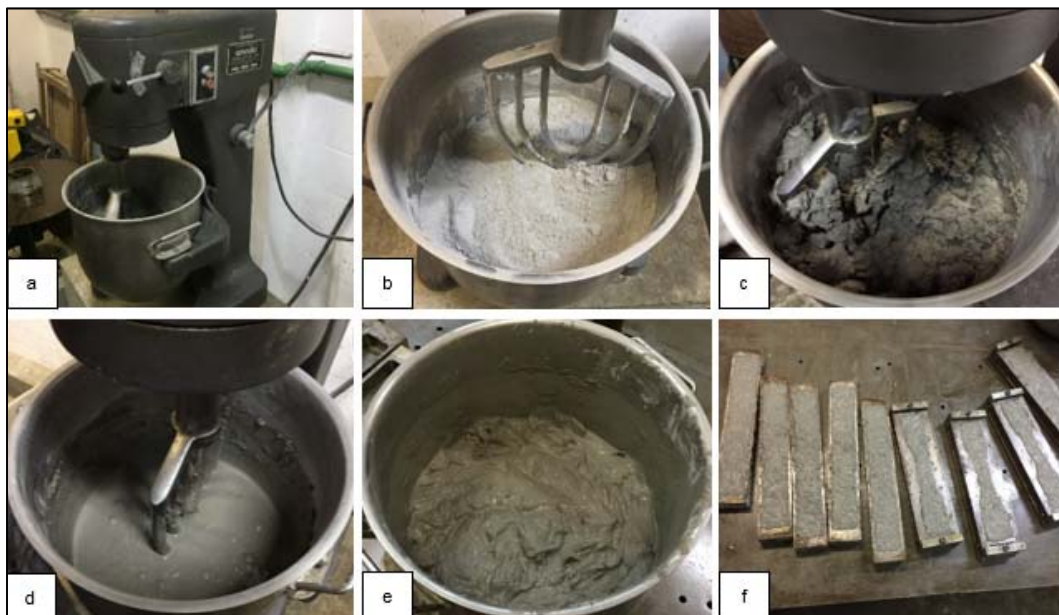
Figura 3.6: Procedimento de moldagem: (a) misturador com capacidade de 20 litros, (b) ingredientes sólidos da matriz misturados, (c) ingredientes sólidos misturados com água, (d) ingredientes misturados após adição do superplastificante, (e) mistura pronta após a adição das fibras de juta, (f) corpos de prova já moldados e prontos para iniciar o processo de cura.
