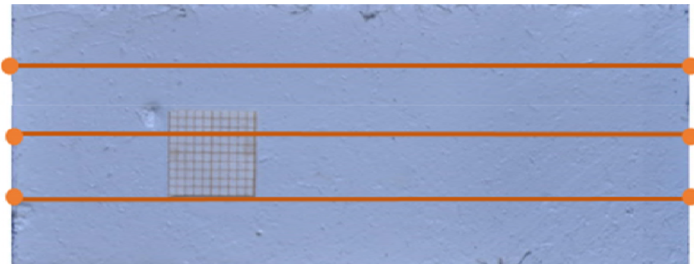
Figura 3.16: Linhas de referência para contagem das fissuras em uma amostra ensaiada na tração direta.
