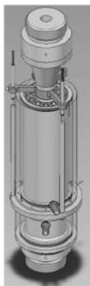
Figura 1.8: Esboço do BTJASPE, um novo dispositivo de teste foi projetado no IFSTTAR destinado a medir automaticamente a evolução da rigidez de um cilindro de concreto em compressão nas primeiras idades (desde o tempo programado até alguns dias) (BOULAY et al. , 2012)
