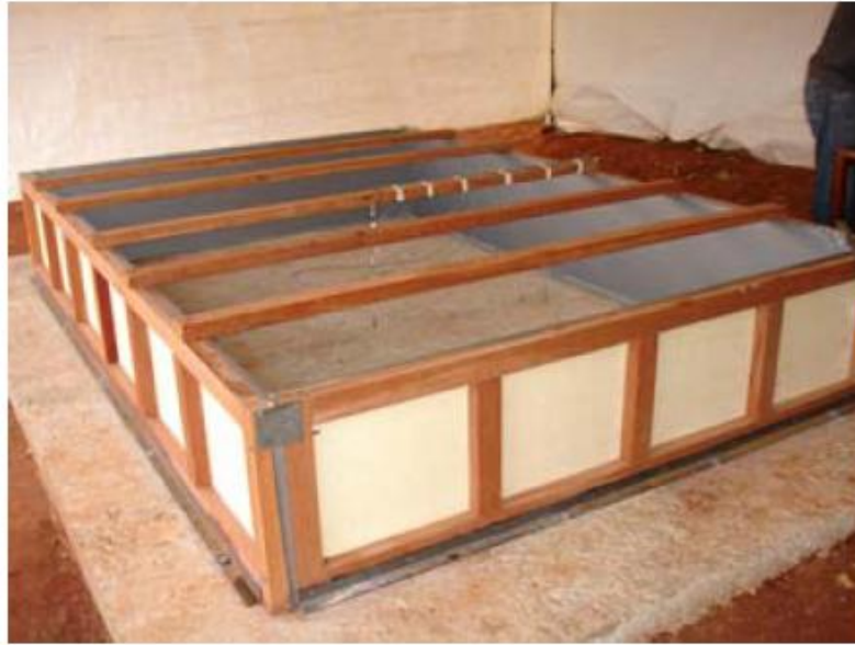
Figura 6.1: Forma da laje ensaiada (FURNAS)
