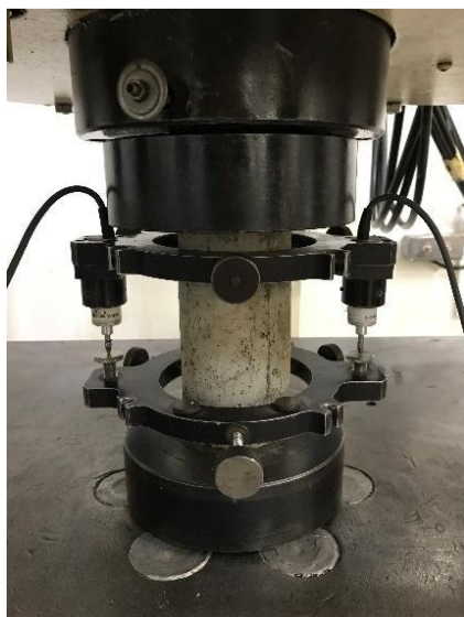
Figura 3.15 – Ensaio resistência à compressão axial na prensa Shimadzu , modelo UH-F250Kn
