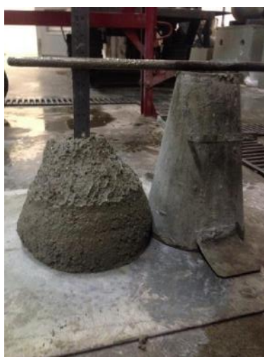
Figura 3.14 – Ensaio de abatimento de tronco de cone
