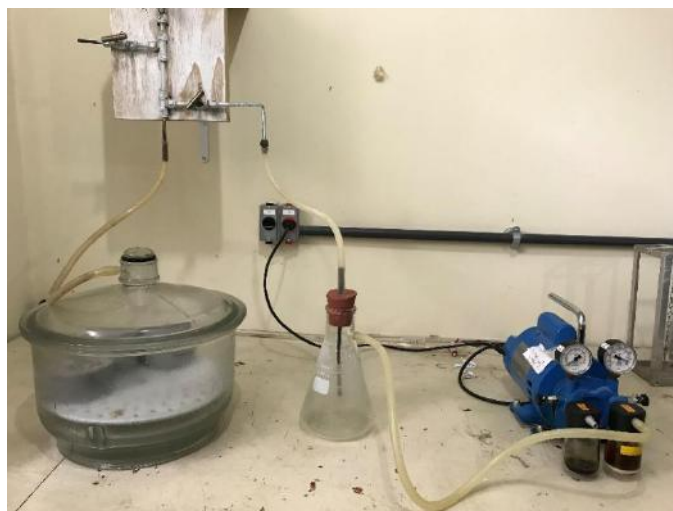
Figura 3.21 – Sistema para preparação da amostra do ensaio de penetração acelerada de íons cloreto
