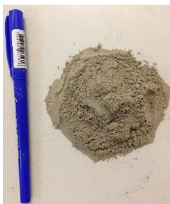
Figura 3.23– Cimento Portland CPV
