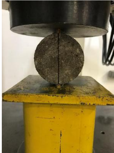
Figura 3.16 – Ensaio resistência à tração por compressão diametral
