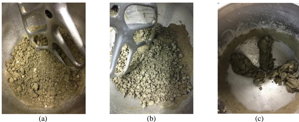
Figura 3.10 – Ensaio de demanda d'água: (a) estado pendular; (b) estado funicular; (c) estado capilar;
