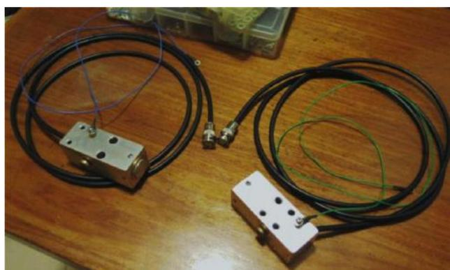
**Figura 41 - Novos sistemas transdutores finalizados.**
