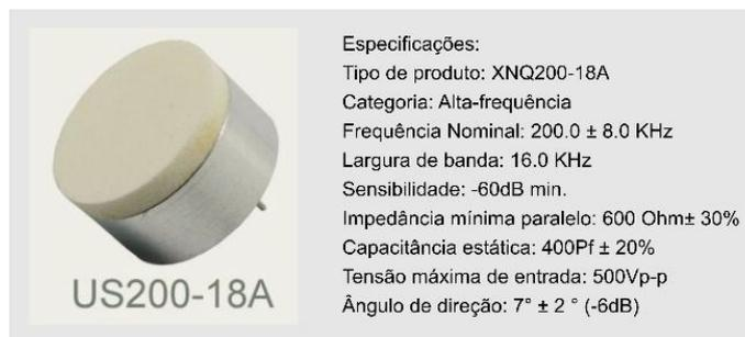
**Figura 39 - Imagem ilustrando o transdutor utilizado. Fonte: Adaptado de Aliexpress (2020).**
