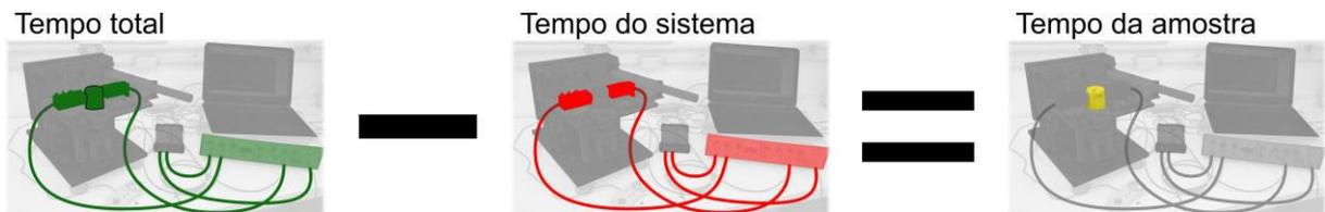
**Figura 49 - Esquema utilizado para obtenção do tempo de propagação de ondas compressoriais através do testemunho em uma direção radial.**
