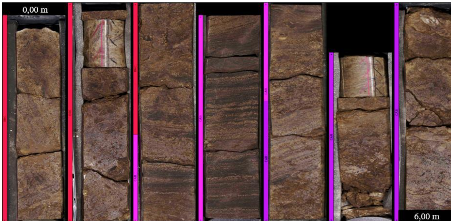
Figura 29 – BRC: Brecha, em vermelho; CAB: Calcário Arbustiforme, em rosa; CAR: Calcário Arborescente, em lilás.
