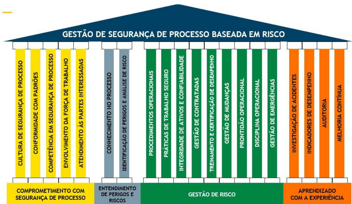
Figura 5 - Blocos e Pilares do RBPS
