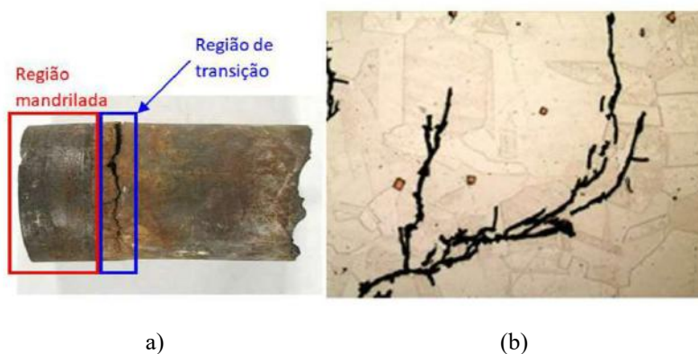
Figura 1.5 - (a) TC causada por CSTCI na RT da ligação tubo-espelho, (b) micrografia mostrando trincas ramificadas típicas de CSTCI [12].
