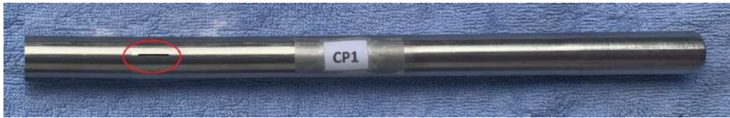
Figura 3.2 - Imagem do CP1 com entalhe longitudinal.
