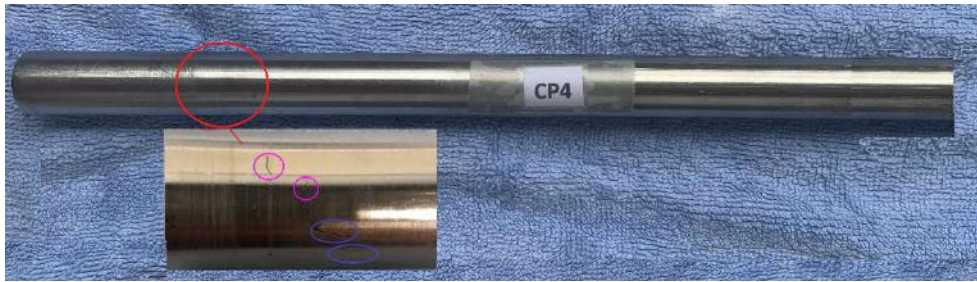
Figura 3.5 - Imagem do CP4 com trincas CSTCl: 2 TC (na cor rosa) e 2 TL (na cor azul)
