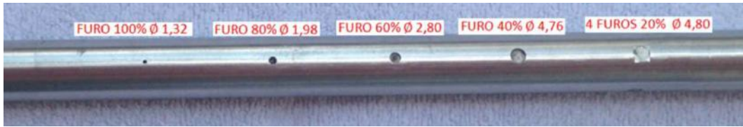
Figura 3.1 - Imagem do padrão ASME V.
