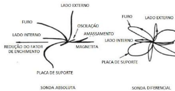
Figura 2.12 - Características dos sinais nas sondas absolutas e diferenciais [25].
