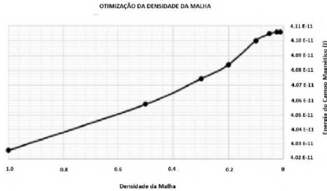
Figura 2.24 - Gráfico da densidade de malha com a Energia Campo Magnético [40].
