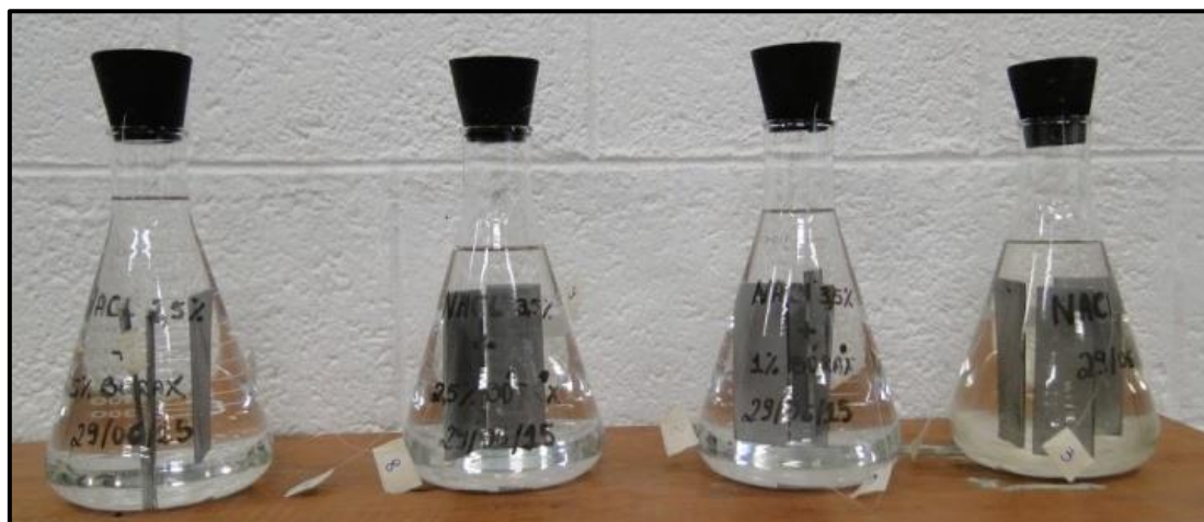
Figura 26. Ensaio de perda de massa de aço carbono em soluções contendo molibdato, Ce (III) ou imidazol em diferentes concentrações e combinações.
