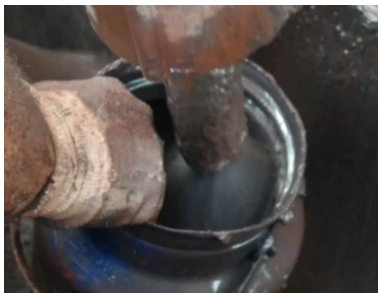
Figura 3.9: Medida da vazão do underflow - usina
