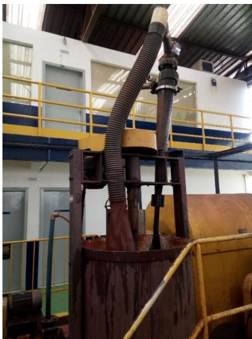
Figura 3.3: Sistema usado nos ensaios de deslamagem na usina piloto (2018)
