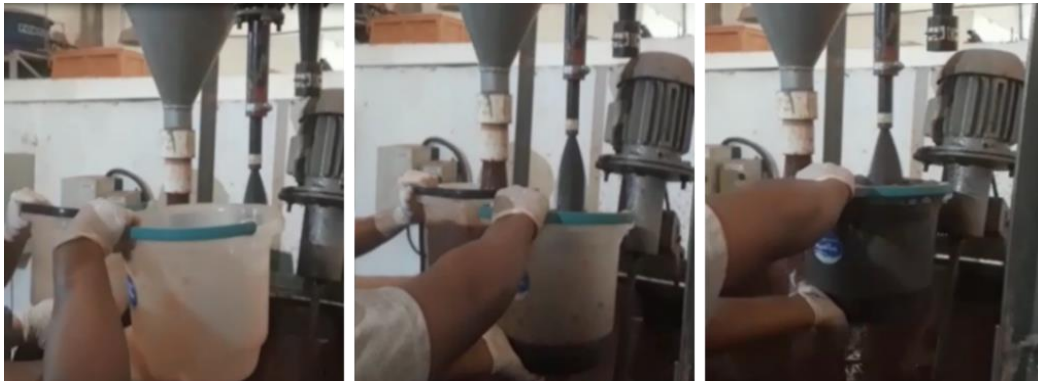
Figura 3.5: Medida da vazão do underflow de teste de deslamagem no LTM
