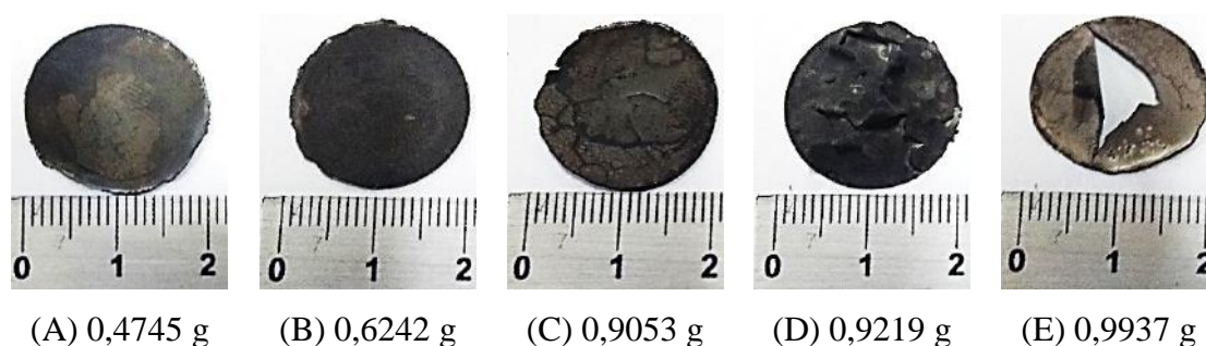
Figura 5.15 – Depósitos produzidos nas eletrólises com duração de 24 h em densidades de corrente de 100 (A), 150 (B), 200 (C), 250 (D) e 300 (E) A.m^{-2} .
