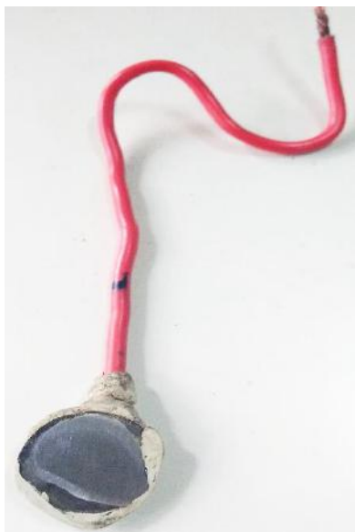
Figura 4.3 – Eletrodo de cobalto utilizado nos ensaios de voltametria para análise da nucleação do cobalto.
