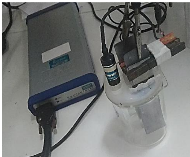
Figura 4.1 – Célula eletrolítica com eletrodos utilizados nos ensaios de voltametria.
