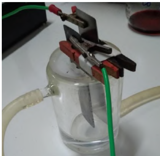
Figura 4.4 – Célula eletrolítica utilizada nos testes de eletrólise com duração de 24 h.
