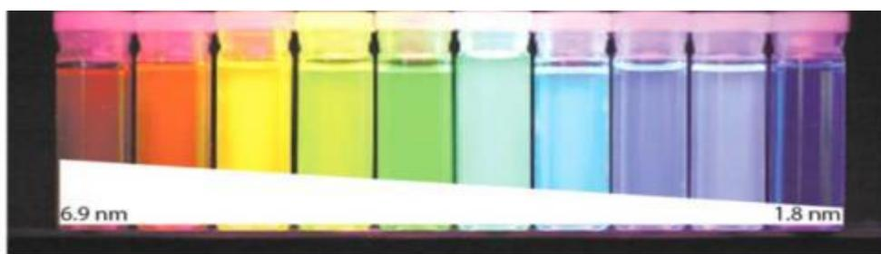
**Figura 1** – Pontos quânticos emitindo fluorescência em diferentes comprimentos de onda são exemplos da aparência brilhante da fluorescência. Adaptado de (CHERN et al., 2019).
