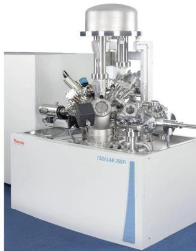
**Figura 17**– Espectrômetro ESCALAB 250Xi, produzido pela *Thermo Scientific*. Fonte: (THERMOFISCHER SCIENTIFIC, 2020).
