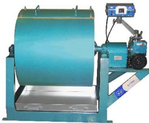
Figura 30. Moinho padronizado para o ensaio Los Angeles.
