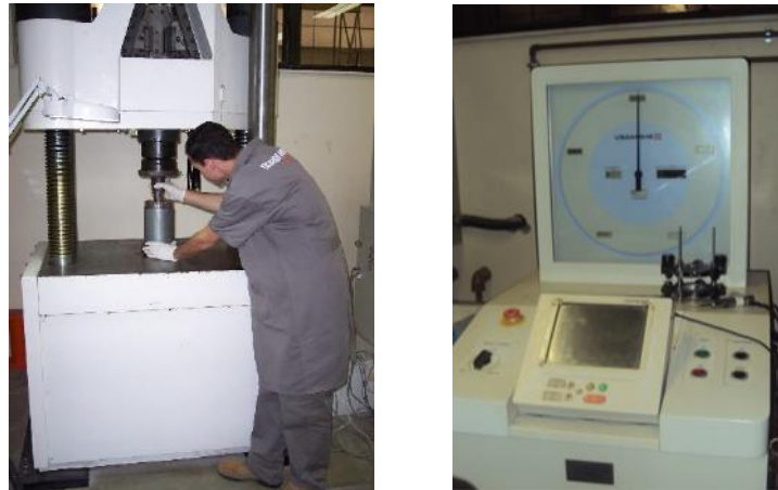
Figura 43. Prensa e equipamento de medição da força e deslocamento aplicado.
