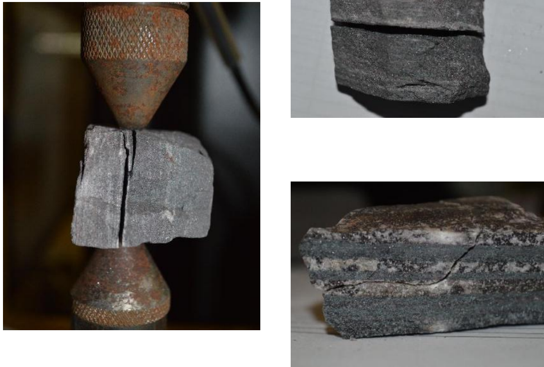
Figura 56. Esquema do ensaio de carga pontual paralelo à formação bandada, ilustrando o caminho preferencial da fratura.
