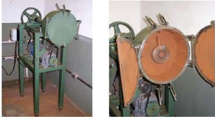
Figura 31. Tambor usado no ensaio de abrasividade de Bond Ai.
