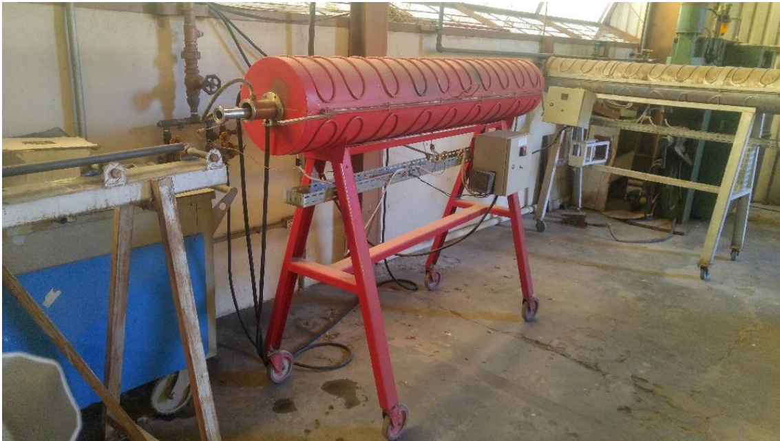
Figura 26- Forno horizontal tubular utilizado para os tratamentos térmicos de solubilização deste trabalho.
