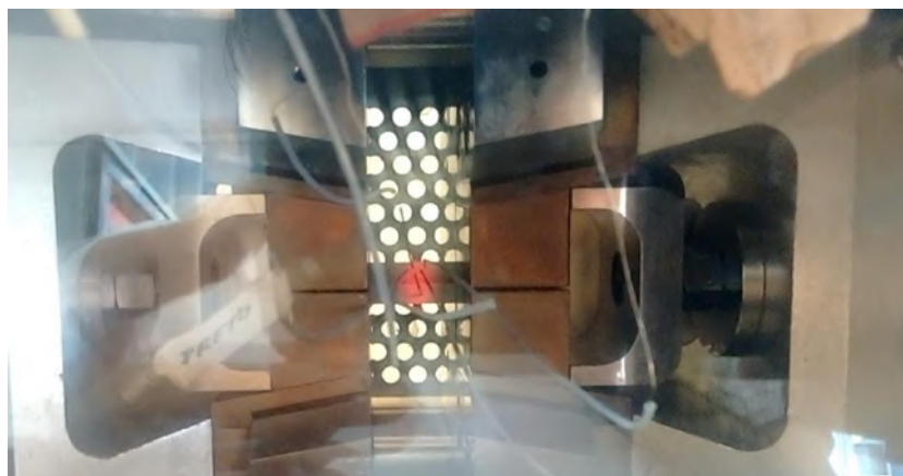
Figura 47 – Esquema de montagem do corpo de prova simulado na Gleeble.
