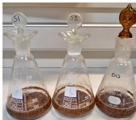
Figura 3.12: Serragem livre de extrativos adicionada de solventes para determinação da holocelulose
