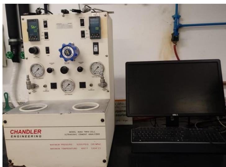
Figura 3.24: Equipamento e computador para aquisição de dados para o ensaio de pulso ultrassônico
