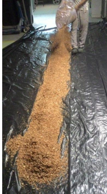
Figura 3.2: Homogeneização do material pelo método de pilha alongada
